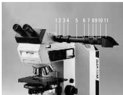
Fig. 35 Dispositif de macroscopie, fixé sur tube HC FSA 25 PE 1 Bride de tube, 2 Bague-chapeau, 3 Optique de projection, 4 Bague-chapeau, 5 Adaptateur macro, 6 Bague de serrage, 7 Bague de réglage du zoom 1:4, 8 Echelle de coefficient de zoom, 9 Echelle du facteur de grossissement de la distance frontale, 10 Echelle de la distance séparant l'objet du bord inférieure du boîtier de miroir, 11 Boîtier de miroir
