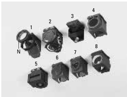
Fig. 20* Barillet d'anneaux de lumière, en lumière réfléchi: 1 Indicateur de la position actuellement dans le trajet des rayons, 2 Description du système de filtres ou réflecteurs, 3 Marquage de la position de montage, 4 Système de filtres, réflecteur ou dispositif de centrage de lampe
