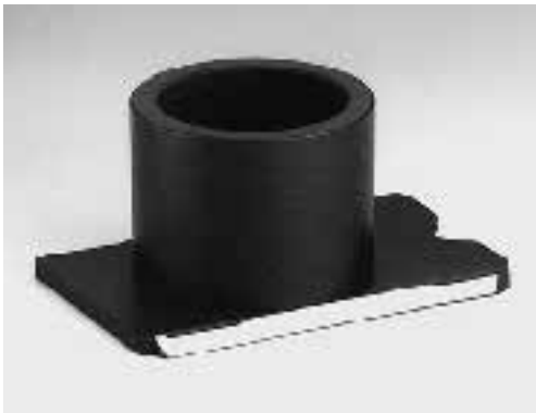
Fig. 64 Piège de lumière pour la microscopie en fluorescence (au lieu de mettre un condenseur). Au lieu du piège à lumière, une bande de métal foncé ou plastique peut être utilisée qui sera placée entre la partie inférieure et supérieure de la platine mouvements croisés sous la préparation.
