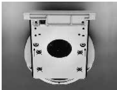
Fig. 26 Revolver de centrage d'objectif*: Vis pour le changement fente de tube/disque de prismes d'objectifs. Les autres vis ne doivent en aucun cas être dévissées.
