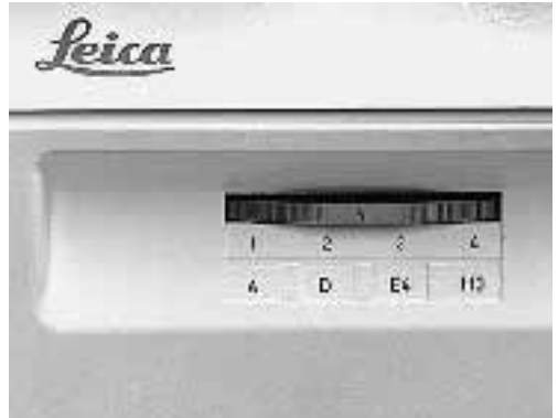
Abb. 19* Frontplatte bei Revolverscheibe Auflicht Aufkleber mit Filterpositionen 1–4, darunter: Aufkleber der korrespondierenden Filtersysteme bzw. Reflektoren
