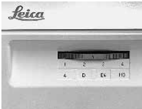
Fig. 19* Partie frontale avec barillet, en lumière réfléchi: Ligne supérieure: Etiquette autocollante avec emplacement des filtres de 1 à 4, Ligne inférieure: Etiquette autocollante avec systèmes de filtres (ou réflecteurs) correspondants
