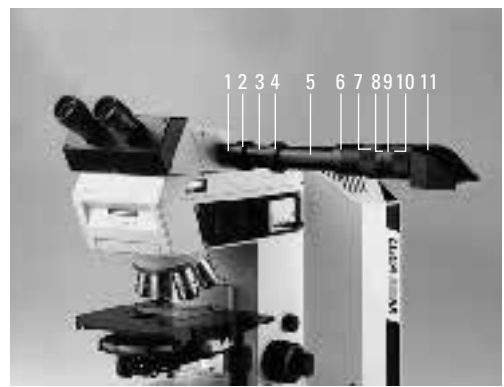
Abb. 35 Makroeinrichtung am Tubus HCFSA 25 PE 1 Tubusflansch, 2 Überwurfring, 3 Einspiegeloptik, 4 Überwurfring, 5 Makroadapter, 6 Schraubring, 7 Zoom-Einstellung 1:4, 8 Skala-Zoom-Faktor, 9 Skala-Vergrößerungsfaktor des Arbeitsabstandes, 10 Skala-Objektdistanz von Unterkante Spiegelgehäuse, 11 Spiegelgehäuse
