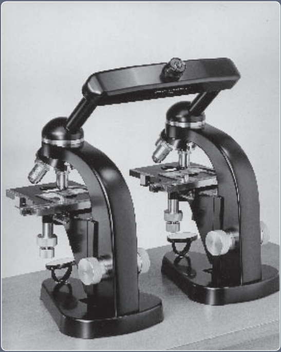
Microscopio de comparación con monocular, Ernst Leitz Wetzlar, año de construcción 1955
