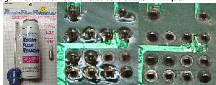
A gauche: Solution chimique de retrait de flux. Au milieu: des plots brillants après soudage. A droite: flux retiré à l'aide de la solution chimique.
