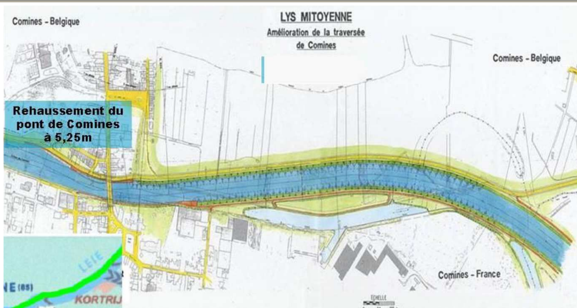
Figure 9 : Adaptation de la Lys dans la traversée de Comines (source SPW)
