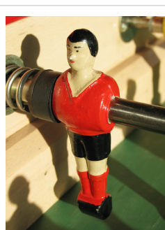
Les lignes de figurines d'un Babyfoot sont liées à la table par un pivot glissant.
