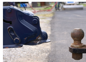
Un attelage de caravane ou de remorque légère est modélisable par une liaison rotule.
