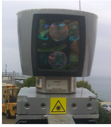
Fig. 1: Velodyne HDL-64E lidar sensor
