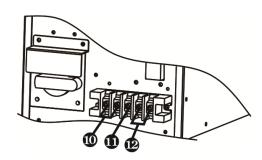
Diagram 3: 6K(L) Input/Output Terminal
