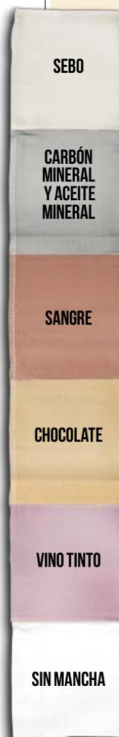
• Verificar el efecto del tallado, principalmente debido a la fuerza mecánica, la primera pieza de prueba que se utiliza se ensucia con sebo y la segunda con una mezcla de carbón mineral y aceite mineral.
