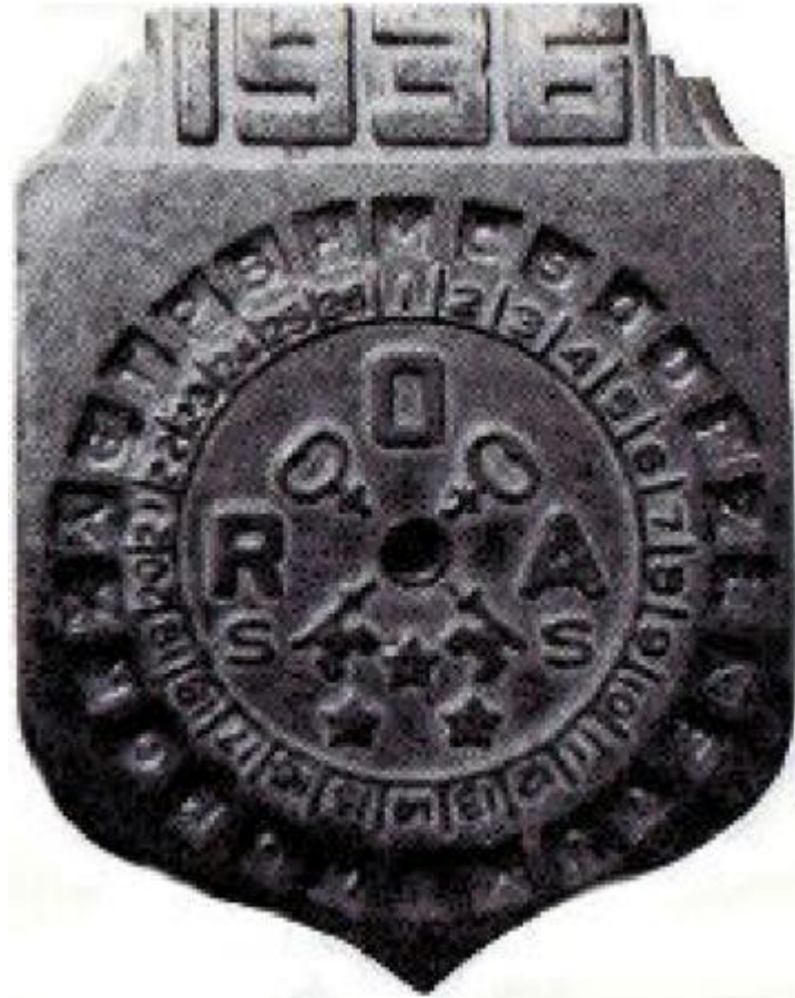
Figura 32. Codeógrafo del Capitán Medianoche que codifica cada letra de texto llano (disco externo) con un número (disco interno) en vez de cómo una letra.
