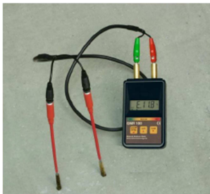
Měření kartáčovou sondou GBSL 91
