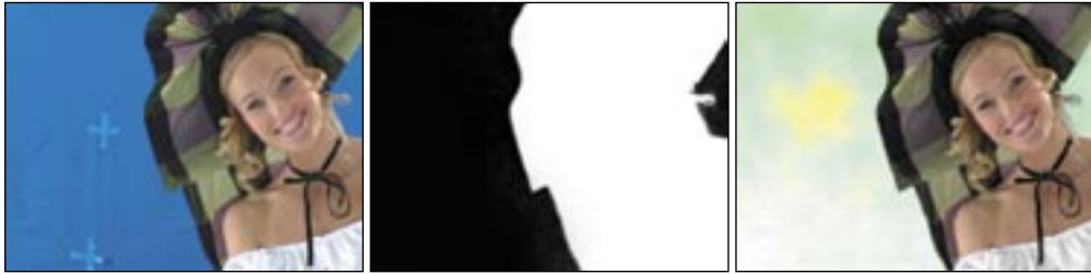
Fig. 16 : De gauche à droite : l'image originale, le masque de découpe et le composite.
