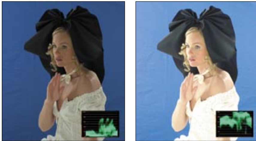
Fig. 4 : A gauche, l'image est sous-exposée : les noirs sont écrasés à 0 mV. A droite, l'image est sur-exposée : les blancs sont brûlés à 700 mV.
