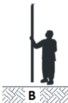
Gambar 3.5 Memasang Rambu Ukur Dengan Tegak
