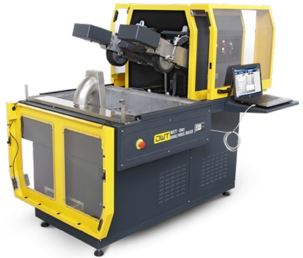
Detalle del sistema elevador motorizado que eleva automáticamente las ruedas al final del ensayo.
