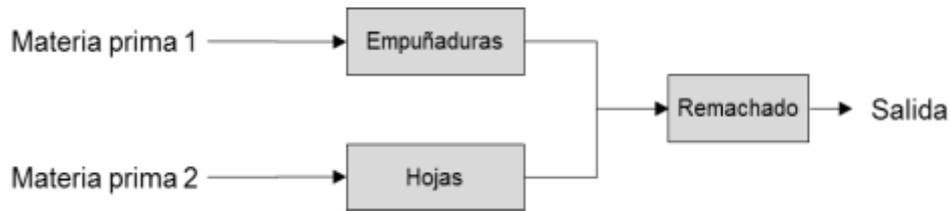
**Figura 2-3.** Esquema simplificado de un proceso de fabricación de cuchillos.
