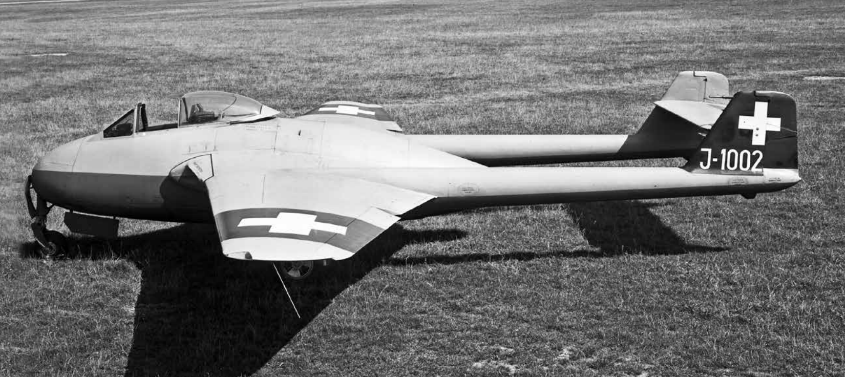
«Vampire» DH-100 Mk 1. Auffallend: die trapezförmigen Seitenleitwerke.
