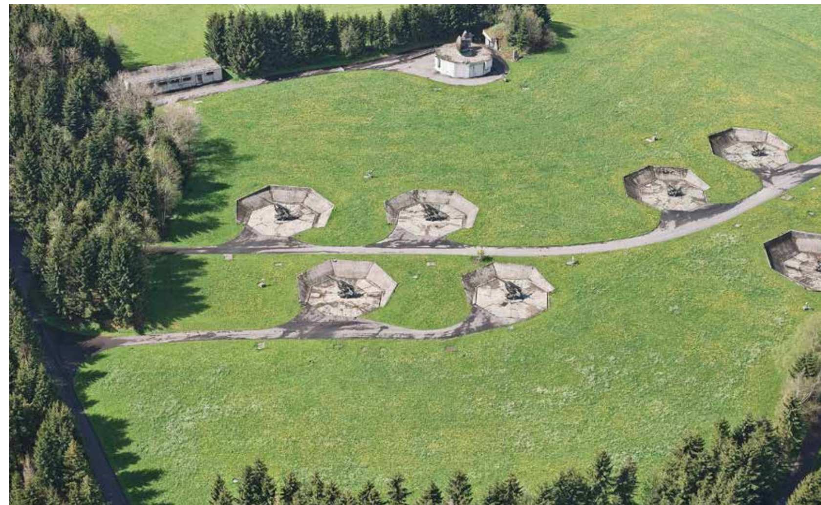
Übersicht über eine BL 64 Stellung mit Beleuchtungsradar und 2 Werfergruppen
