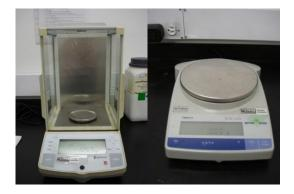
Es un instrumento que nos permite medir la masa de un objeto. Para realizar las mediciones se utilizan patrones de masa cuyo grado de exactitud depende de la precisión del instrumento. El rango de medida y precisión de una balanza puede variar desde varios kilos (con precisión de gramos), en balanzas industriales y comerciales; hasta unos gramos (con precisión de miligramos) en balanzas de laboratorio.
