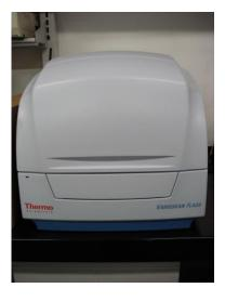
Lector de Absorbancia, Fluorescencia y Luminiscencia en el espectro ultravioleta y visible que soporta la lectura de platos desde 6 hasta 1512 pozos.
