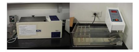
El baño maría (o baño de María) es un método que permite suministrar temperatura uniforme a una sustancia líquida o sólida o para calentarla lentamente, sumergiendo el recipiente que la contiene en otro mayor con agua que se lleva a o está en ebullición. La limpieza de este equipo de realizarse mínimo cada dos meses.
