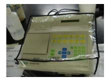
Un espectrofotómetro es un instrumento usado en la física óptica que sirve para medir, en función de la longitud de onda, la relación entre valores de una misma magnitud fotométrica relativos a dos haces de radiaciones. También es utilizado en los laboratorios de química para la cuantificación de sustancias y microorganismos.
