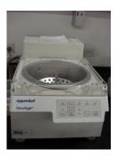
Las centrifugas con sistema de vacío conocidas como *Vacufuge* son centrifugas que están diseñadas para concentrar y purificar DNA, RNA, nucleótidos y otro tipo de muestras liquidas en pequeño volumen.
