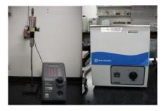
Es un aparato que permite la aplicación de ultrasonidos a una suspensión celular. La intensa agitación producida destruye las membranas celulares. Dependiendo de la frecuencia, intensidad y energía aplicada se pueden destruir asimismo las estructuras subcelulares e incluso solubilizar complejos proteicos. Se suele aplicar en frío para evitar el sobrecalentamiento de las muestras que podría provocar la desnaturalización de las proteínas.
