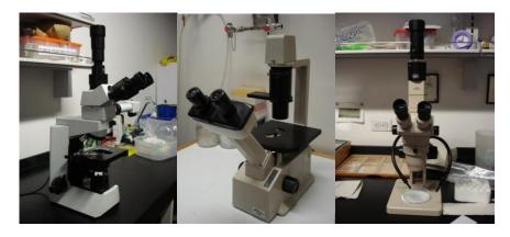
El microscopio estereoscópico, el cual es binocular, con aumentos de 4 a 40 veces, permite observar muestras opacas y realizar disecciones de estructuras en organismos pequeños, ya que en él puede manipularse la muestra mientras se observa. Proporciona una imagen tridimensional.
