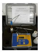
El pHmetro es un sensor utilizado en electroquímica para medir el pH de una disolución. Consiste en un par de electrodos, uno de calomel (mercurio, cloruro de mercurio) y otro de vidrio, sumergidos en la disolución en la que queremos encontrar el pH. La barita de soporte del electrodo es de vidrio común y no es conductor, mientras que el bulbo sensible, que es el extremo sensible del electrodo, está formado por un vidrio polarizable (vidrio sensible de pH).
