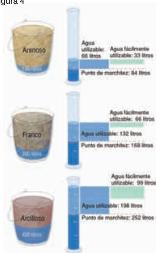
Almacenamiento de agua en el suelo, valores medios para diferentes texturas y para cultivos poco sensibles a la sequía
