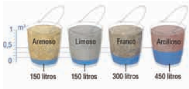
Tipos de suelo y capacidad para almacenar agua
