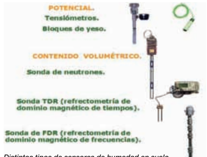
Distintos tipos de sensores de humedad en suelo
