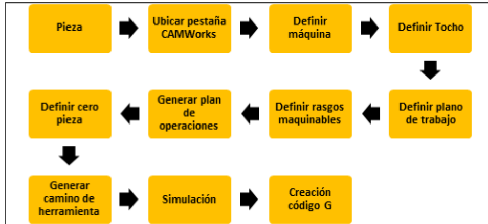
Figura 2.18 Pasos para la simulación y creación del código G
