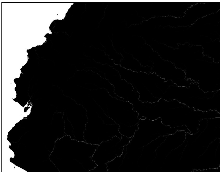
Figura N° 3.2.2: Información de Acumulación de Flujo de la misma parte del territorio sudamericano, mostrada tal como ArcGis lo presenta originalmente, bajo el tipo "Stretched" en escala de grises.
