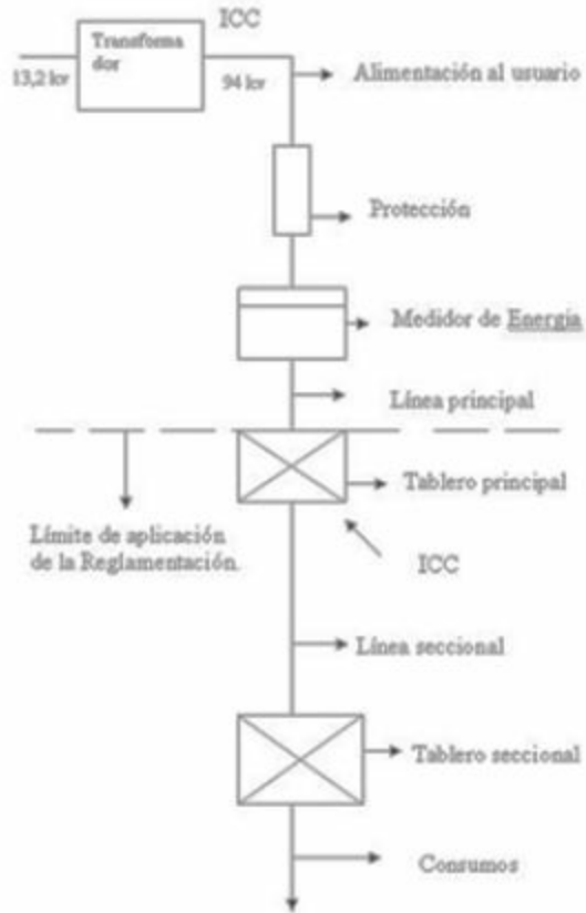
Esquema de Transformación de Media tensión a Baja tensión
