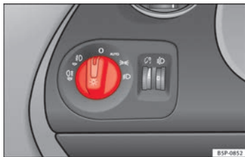
Fig. 69 Encendido automático de luces.
