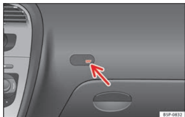
Fig. 23 Testigo de control de la desactivación del airbag del acompañante.
