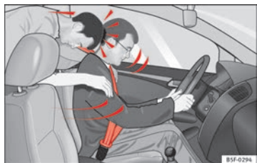
Fig. 9 El ocupante del asiento trasero que no lleve puesto el cinturón de seguridad se verá lanzado hacia adelante sobre el conductor que sí lleva el cinturón.
