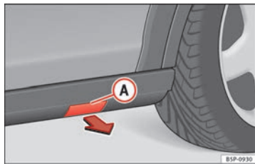
Fig. 176 Talonera de plástico con tapa para el anclaje del gato.
