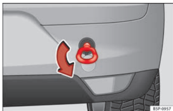
Fig. 211 Atornillado de la argolla de remolque en la parte trasera del vehículo.
