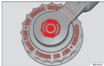
Fig. 167 Vano motor: tapón del depósito del líquido de frenos.
