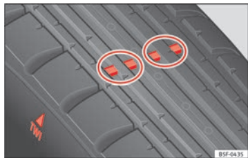
Fig. 168 Indicadores de desgaste del perfil del neumático.
