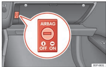
Fig. 22 En la guantera: conmutador con llave para activar y desactivar el airbag del acompañante.
