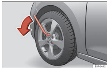
Fig. 173 Cambio de rueda: aflojar los tornillos de rueda.
