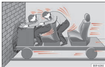
Fig. 7 El vehículo choca con el muro: los ocupantes no llevan abrochado el cinturón.
