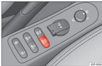
Fig. 136 Consola central: conmutador de control del sistema de gas.
