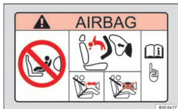
Fig. 16 Parasol del lado del acompañante: adhesivo del airbag.
