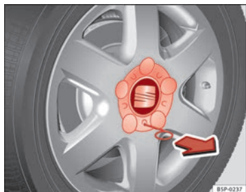
Fig. 171 Cambio de rueda: retirar el embellecedor de la rueda.
