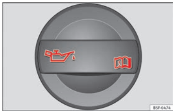
Fig. 160 Tapón de la boca de llenado de aceite del motor en el vano motor.
