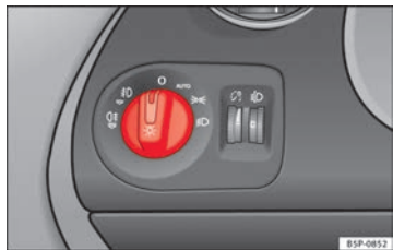
Fig. 68 Detalle del tablero de instrumentos: mando de las luces, faros antiniebla y luz trasera antiniebla.
