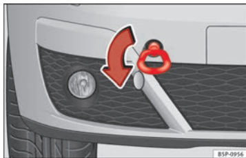
Fig. 210 Atornillado de la argolla de remolque en la parte delantera derecha del vehículo.
