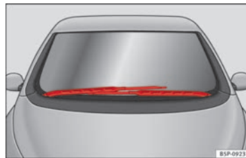
Fig. 163 Limpiacristales en la posición para realizar el cambio.
