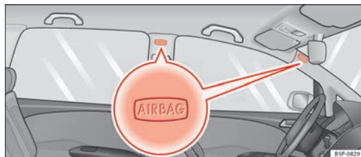
Fig. 26 Ubicación de los airbags para la cabeza en el lado izquierdo del vehículo.
