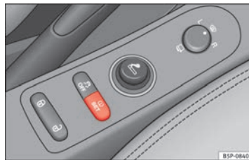
Fig. 48 Consola central: tecla del sistema de control de los neumáticos.
