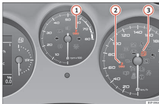
Fig. 47 Testigos de control y de advertencia del cuadro de instrumentos en vehículos con GLP.
