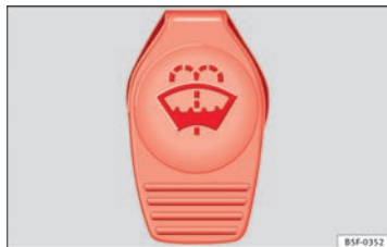
Fig. 162 Tapón del depósito del lavacristales en el vano motor. ►
