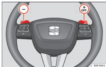
Fig. 144 Volante con palancas para cambio automático.
