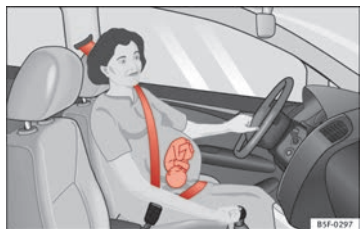
Fig. 14 Colocación de la banda del cinturón en el caso de mujeres embarazadas.
