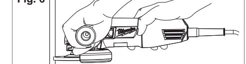
**AVISO** A utilização da parte frontal do disco de corte (como em um polimento) faz com que o disco rache e se rompa, causando ferimentos graves.
