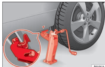
Fig. 67 Colocación del gato.
