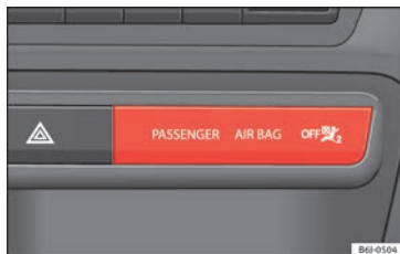
Fig. 86 Parte central del tablero de instrumentos: testigo de control de la desactivación del airbag del acompañante.
