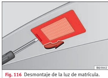
Fig. 116 Desmontaje de la luz de matrícula.
