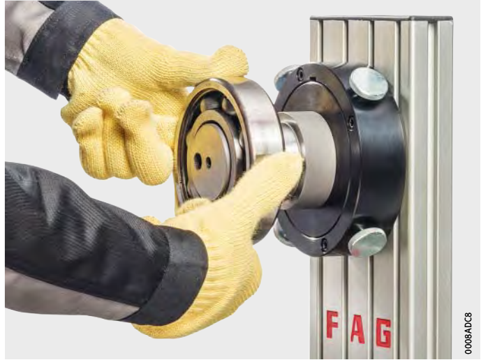
Figura 14 Montaje de las piezas calientes del rodamiento
