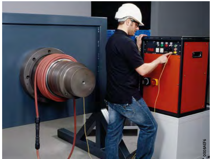
Figura 10 Desmontaje de anillos interiores mediante inductores flexibles
