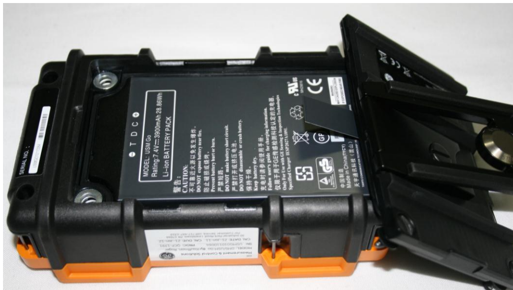
Figura 6.- Compartimiento de baterías
