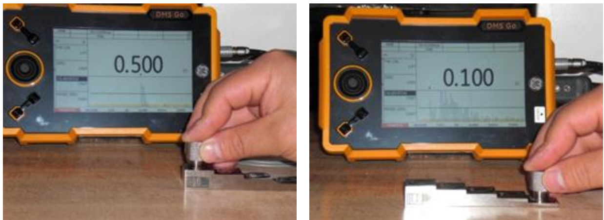
Figura 39.- Comprobación de la calibración
