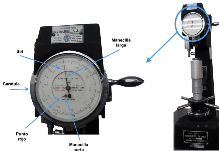
Figura 3.16. Detalle de la carátula del equipo Rockwell analógico.
