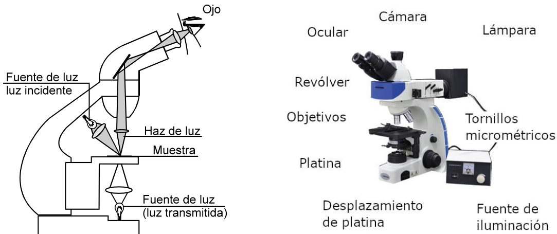
Figura 2.2. Microscopio metalográfico convencional (de reflexión) de luz visible y partes importantes.
