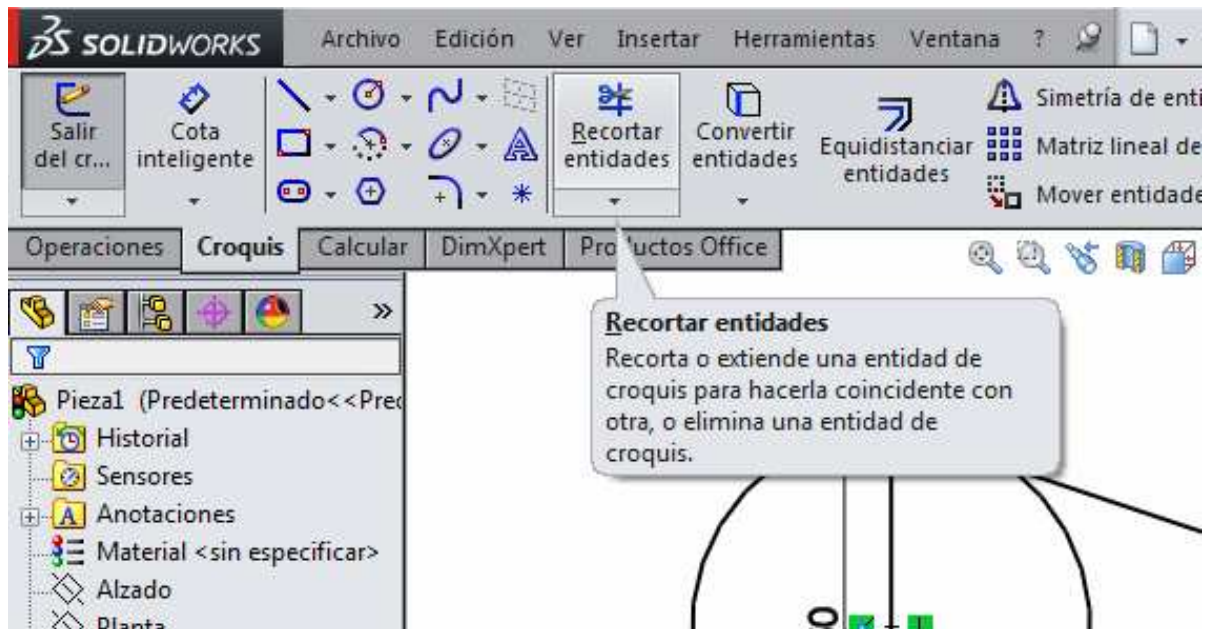
Figura 2.16. Comando para recortar líneas
