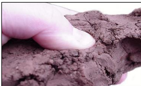
Figura 11. Prueba penetración de pulgar
