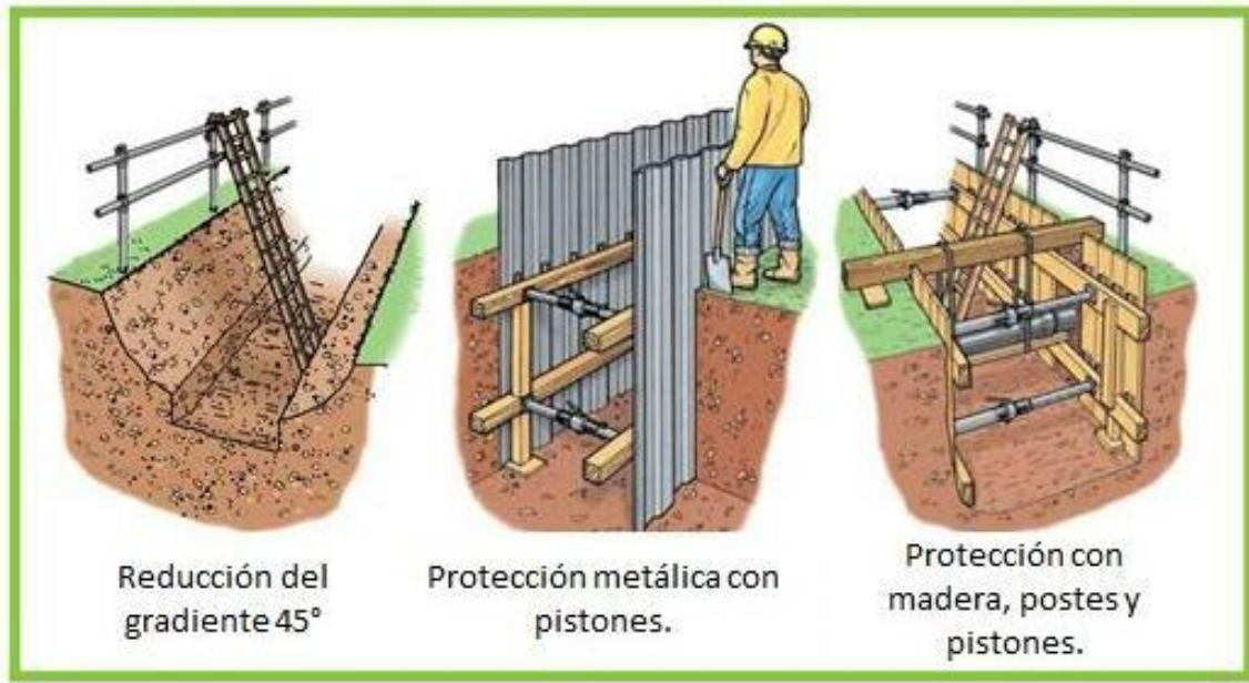
Figura 4. Buenas prácticas para trabajos en Zanjas
