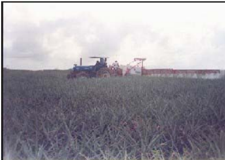
Fumigadora de bragas utilizable en grandes extensiones de siembra. Economiza la utilización de productos químicos.
