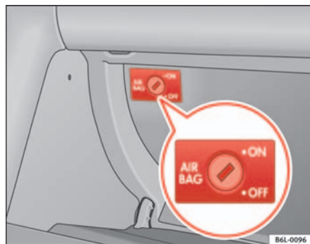
Fig. 25 En la guantera: conmutador con llave para activar y desactivar el airbag del acompañante
