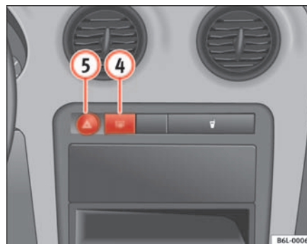
Fig. 58 Tablero de instrumentos: conmutador de luneta térmica ▶
