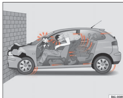
Fig. 7 El vehículo choca con el muro: los ocupantes no llevan abrochado el cinturón
