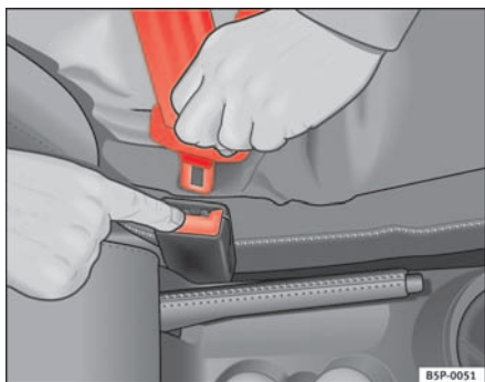
Fig. 15 Retirar la lengüeta del cierre del cinturón
