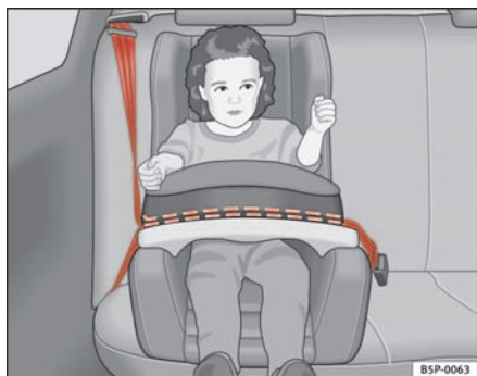
Fig. 28 Asiento para niños del grupo 1 montado en el asiento trasero en la dirección de la marcha.
