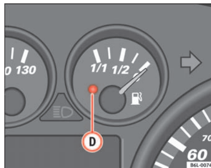
Fig. 34 Indicador de nivel del depósito de combustible
