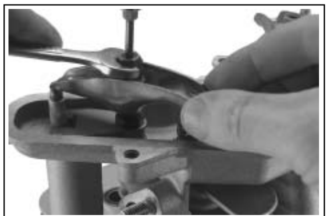
Figura 8-28. Rimozione di vite e dado di regolazione.
