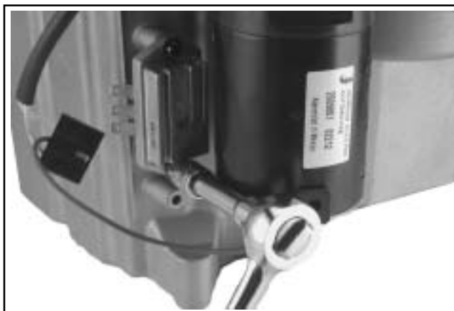
Figura 8-5. Rimozione del raddrizzatore-regolatore.
