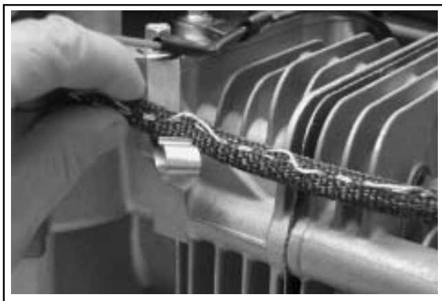
Figura 8-20. Rimozione del cavo dal fermo (unità schermate RFI).
