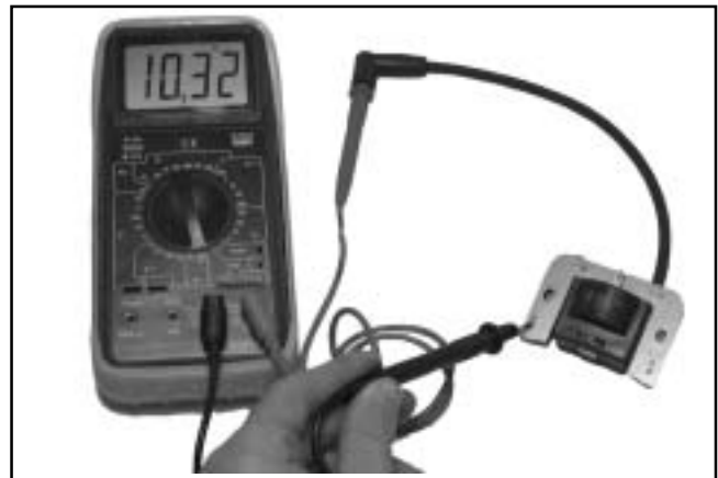
Figura 7-5. Prova del secondario del modulo di accensione CD.
