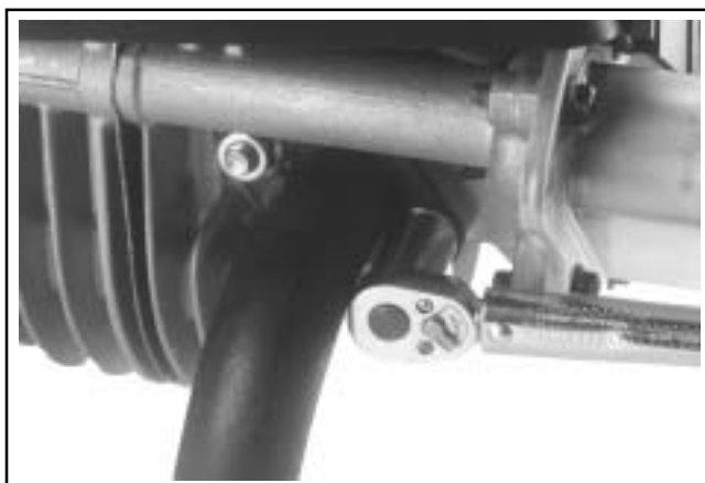
Figura 10-78. Serraggio dei dadi di scarico.
