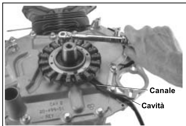
Figura 10-42. Installazione dello statore.
