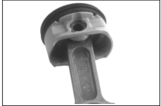
Figura 10-16. Montaggio di pistone e biella.
