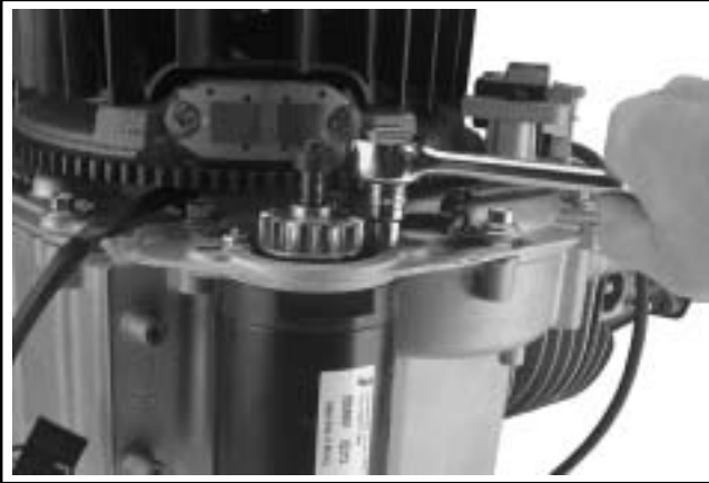
Figura 8-6. Rimozione del motorino di avviamento elettrico.
