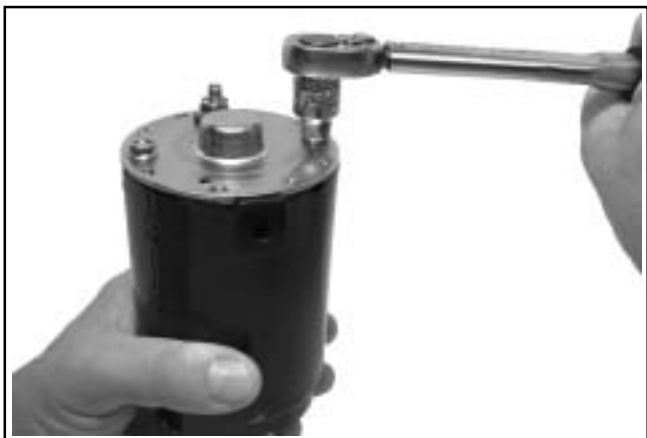
Figura 7-22. Serraggio dei bulloni passanti.
