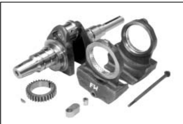
Figura 8-51. Smontaggio del contrappeso.
