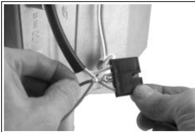
Figura 10-43. Collegamento del cavo B+ al connettore.
