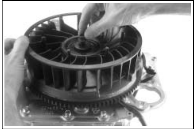
Figura 10-45. Installazione della ventola e fissaggio al volano.
