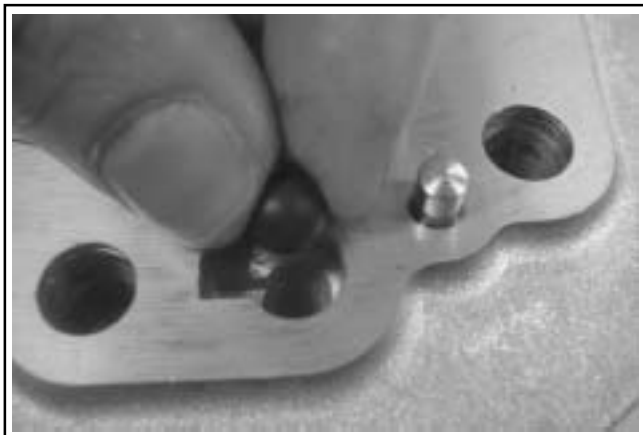
Figura 10-33. Installazione della sfera di ritegno dello spurgo.
