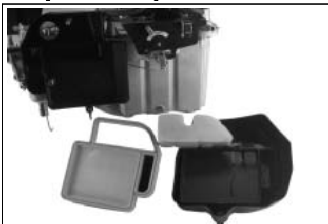
Figura 8-8. Rimozione dei componenti del filtro dell'aria.
