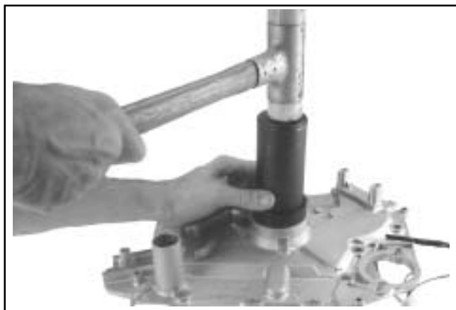
Figura 10-28. Installazione del paraolio lato volano.
