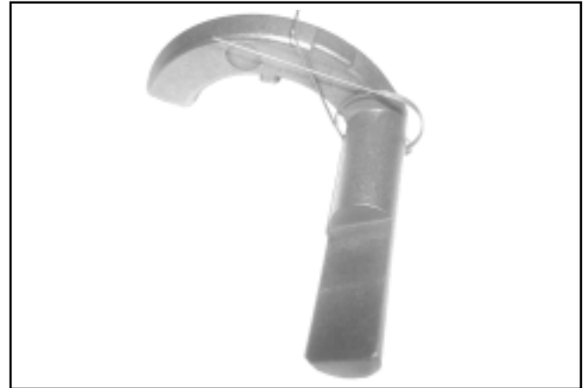
Figura 10-23. Molla installata sul contrappeso dell'ACR.
