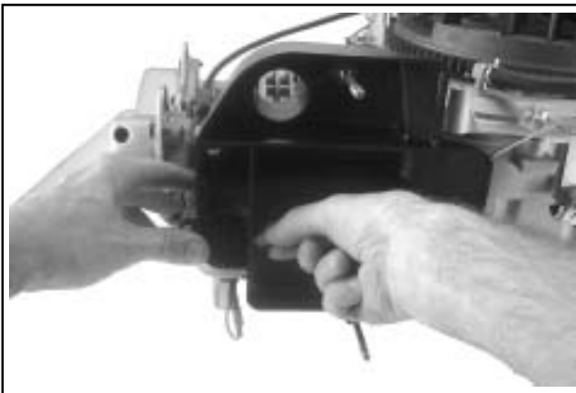
Figura 10-61. Installazione della vite di montaggio. (Modelli con un prigioniero ed una vite).
