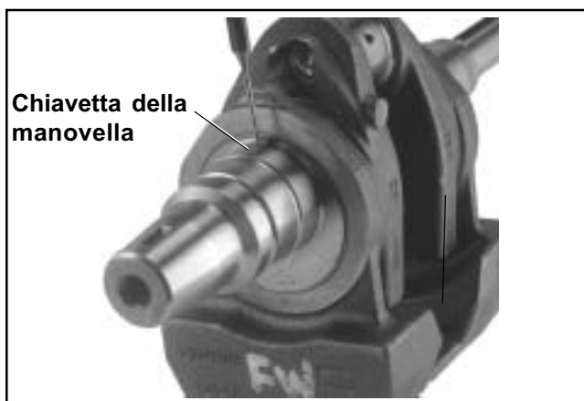
Figura 10-13. Installazione della chiavetta della manovella.
