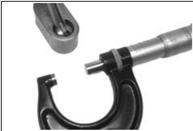
Figura 9-9. Misurazione del diametro interno del foro del pattino guida.
