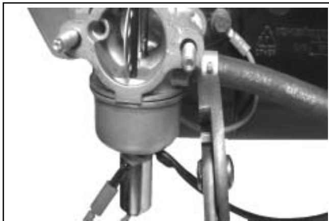
Figura 8-11. Scollegamento del tubo del carburante dal carburatore.
