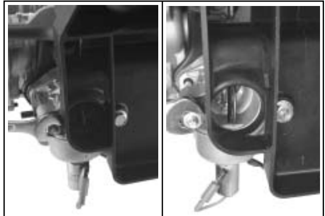
Figura 8-9. Rimozione dei dispositivi di fissaggio della base del filtro dell'aria.
