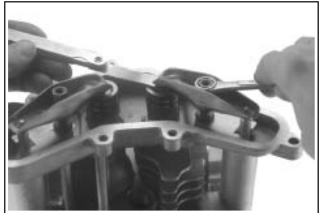
Figura 10-39. Regolazione del gioco delle valvole.
