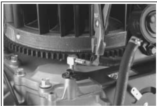
Figura 8-12. Scollegamento del tubo ad impulso dal raccordo.
