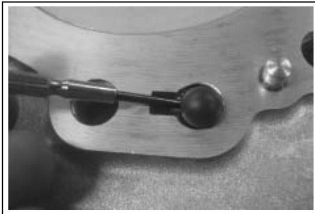
Figura 8-31. Rimozione della sfera di ritegno dello spurgo dal carter.
