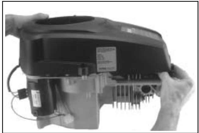
Figura 10-70. Installazione del convogliatore dell'aria.
