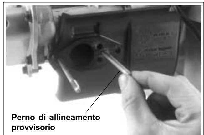
Figura 10-54. Inserimento del perno di allineamento.
