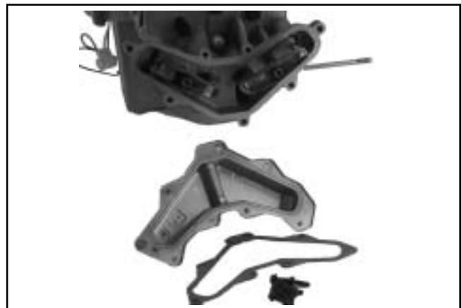
Figura 8-27. Dettagli di coperchio delle valvole e guarnizione.
