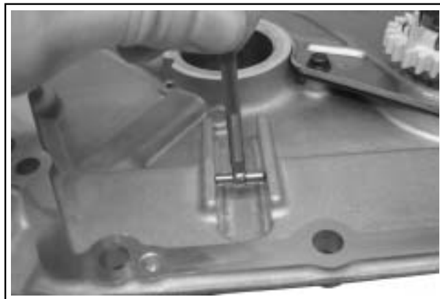
Figura 9-7. Misurazione del canale guida nella piastra di chiusura.
