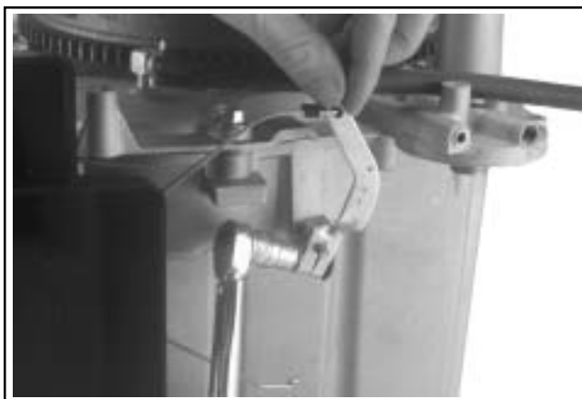
Figura 5-22. Serraggio del dado della leva del regolatore.
