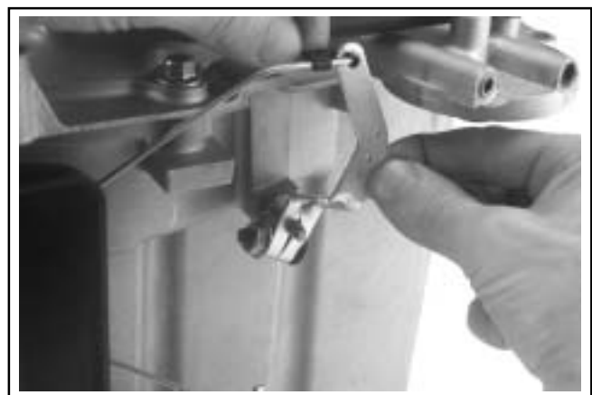
Figura 10-63. Leva del regolatore installata sull'albero.
