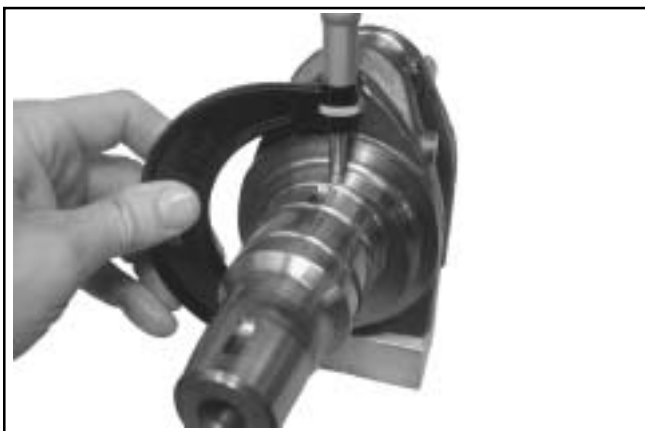
Figura 9-5. Misurazione dell'eccentrico dell'albero motore.
