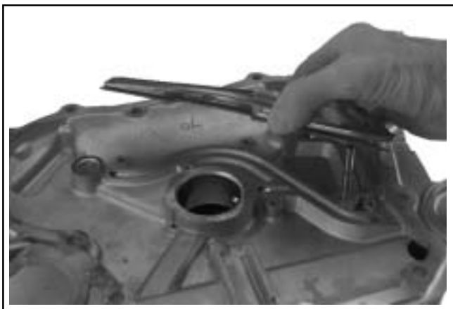
Figura 8-38. Rimozione di coperchio del condotto dell'olio e guarnizione.
