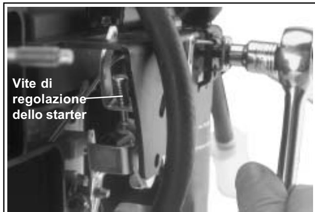
Figura 5-13. Regolazione del comando unico di acceleratore/starter.
