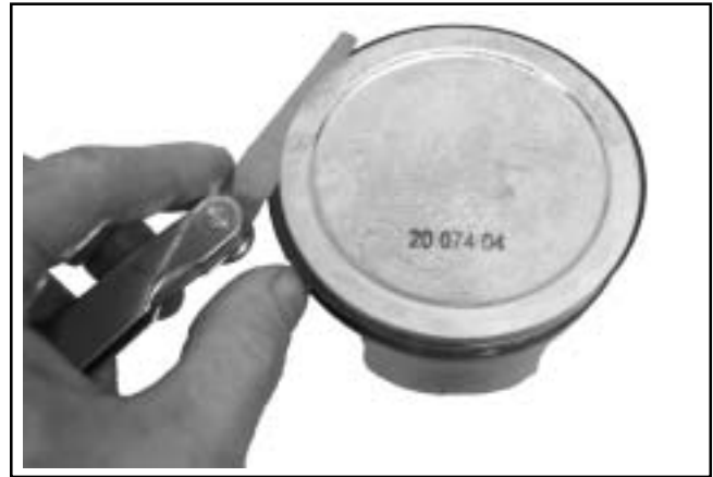
Figura 9-14. Misurazione del gioco laterale dei segmenti del pistone.
