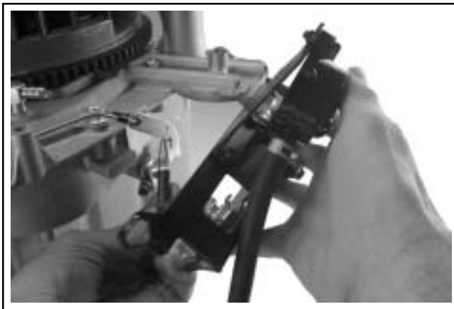
Figura 8-17. Scollegamento della molla del regolatore.
