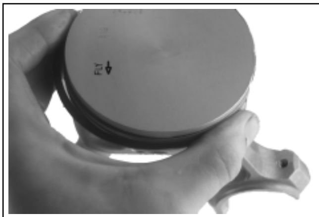
Figura 10-17. Freccia di direzione sul pistone.
