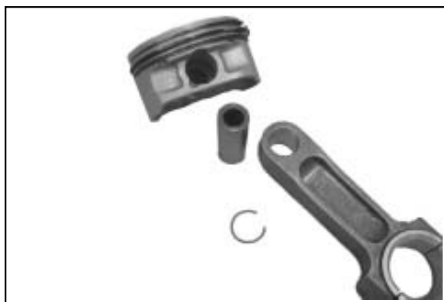
Figura 8-46. Separazione del pistone dalla biella.
