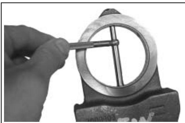
Figura 9-4. Misurazione della superficie portante del contrappeso.
