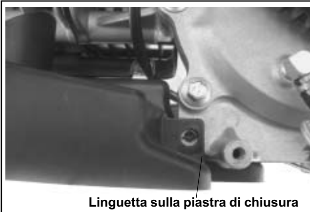
Figura 10-59. Dettagli della linguetta di montaggio superiore della base del filtro dell'aria.
