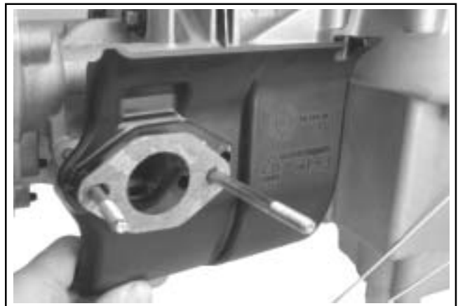
Figura 8-19. Rimozione del deflettore di calore.
