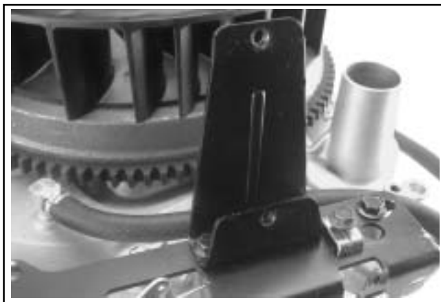
Figura 10-67. Installazione della staffa di montaggio della pompa di alimentazione.
