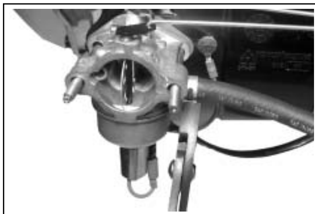
Figura 10-58. Collegamento del tubo del carburante al carburatore.
