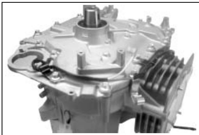
Figura 10-30. Piastra di chiusura installata.
