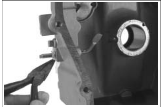
Figura 8-52. Rimozione di perno e rondella.
