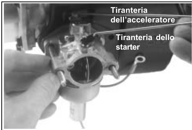
Figura 10-55. Installazione del gruppo carburatore con le tiranterie.
