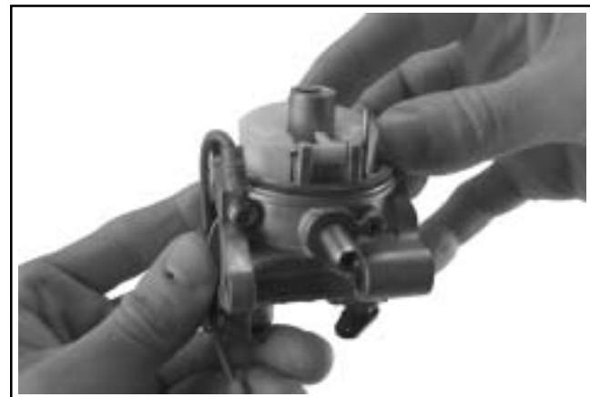
Figura 5-10. Installazione di galleggiante e spillo di ingresso del carburante.
