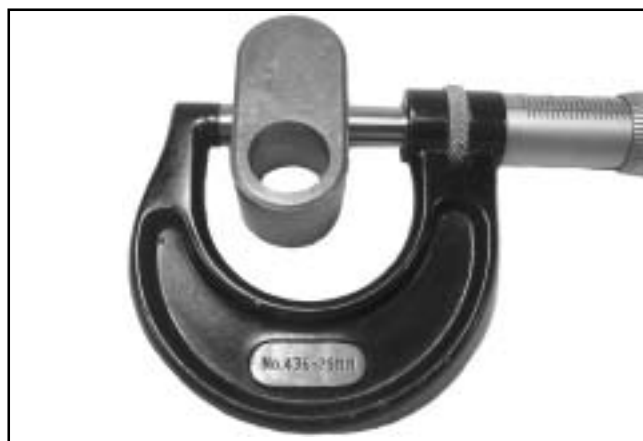
Figura 9-6. Misurazione del pattino guida del contrappeso.
