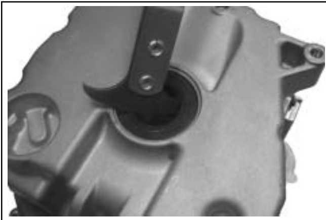
Figura 8-54. Rimozione del paraolio con un estrattore.
