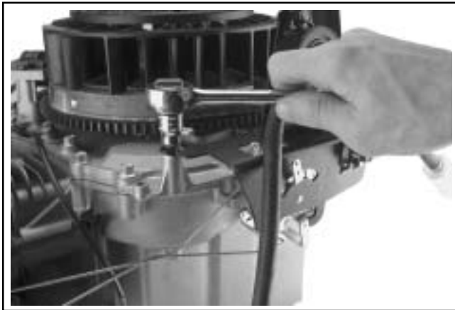
Figura 8-16. Rimozione della staffa del comando di velocità dalla piastra di chiusura.
