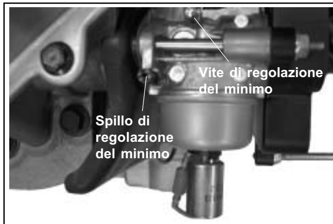
Figura 5-3. Carburatore con getto principale fisso.
