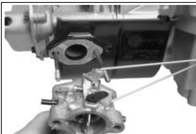
Figura 8-15. Rimozione del carburatore.
