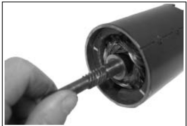
Figura 7-19. Indotto montato nel telaio del motorino di avviamento.
