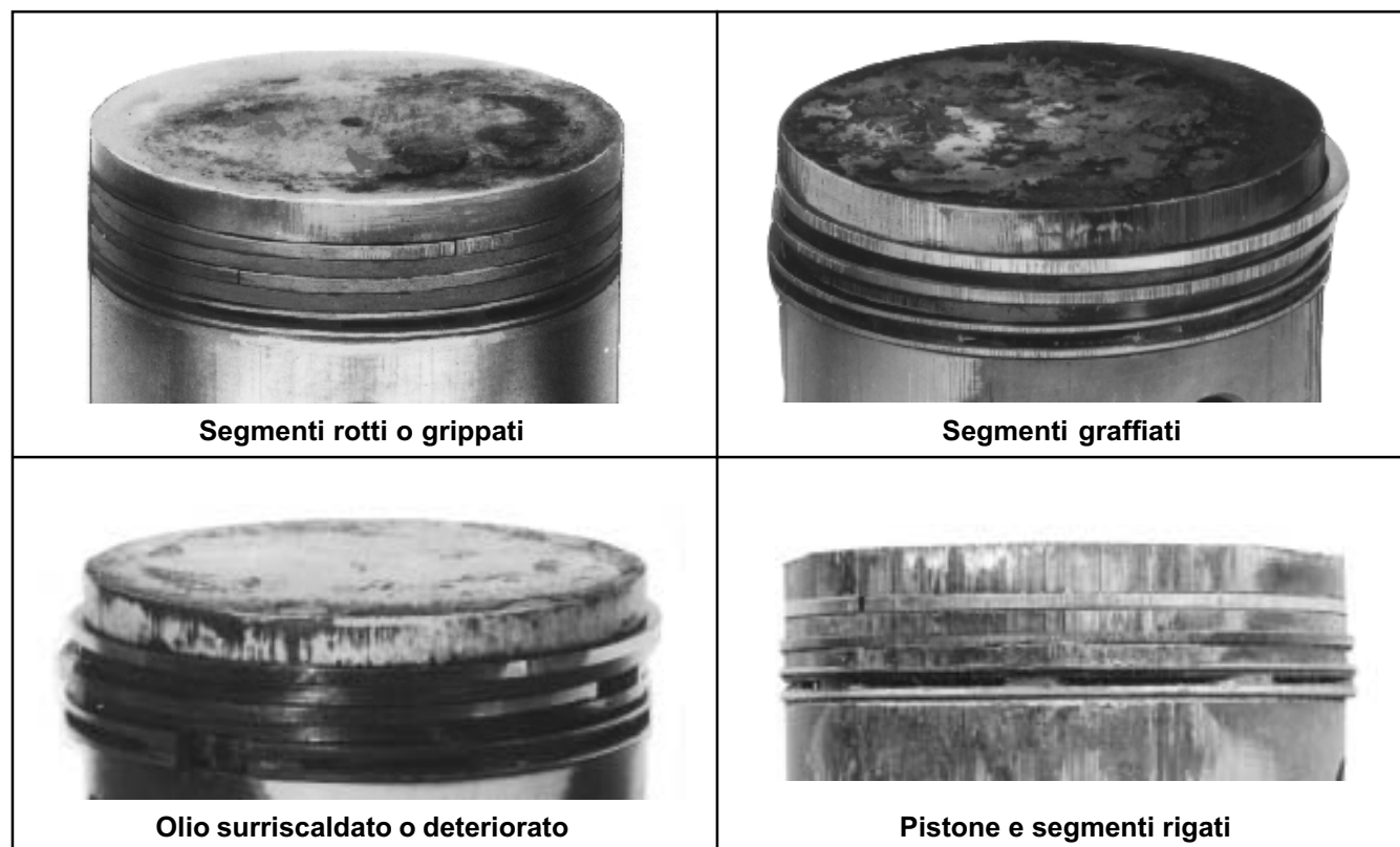
Figura 9-12. Tipi di danni comuni a pistoni e segmenti.
