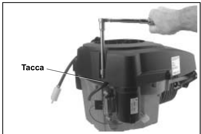
Figura 10-71. Installazione delle viti del convogliatore dell'aria.
