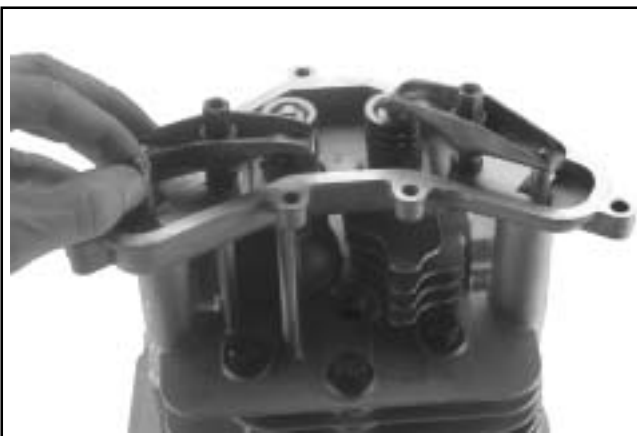
Figura 10-38. Installazione delle aste di spinta e dei gruppi bilanciere.
