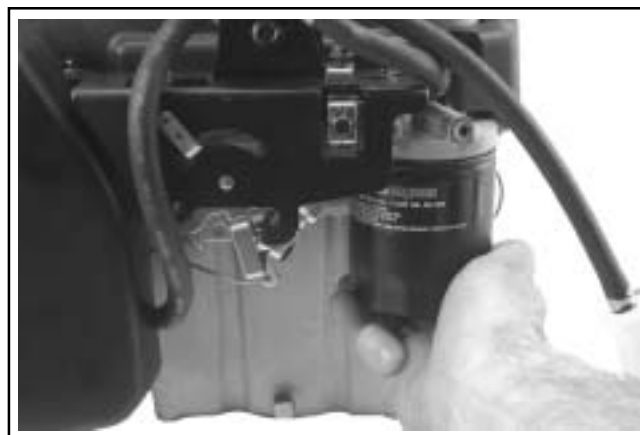
Figura 10-79. Installazione del filtro dell'olio.
