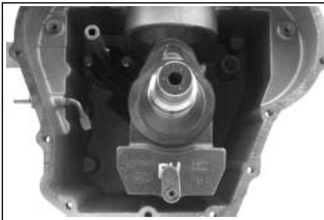
Figura 10-15. Installazione del pattino guida.
