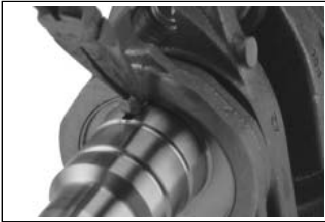
Figura 8-49. Rimozione della chiavetta della manovella.
