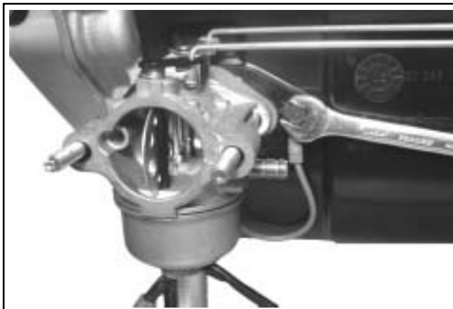
Figura 8-13. Rimozione di vite del deflettore di calore e cavo di massa.
