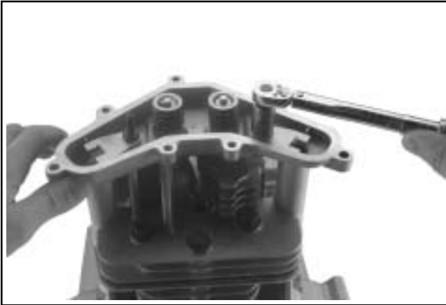
Figura 10-37. Installazione di piastre guida e prigionieri dei bilancieri.
