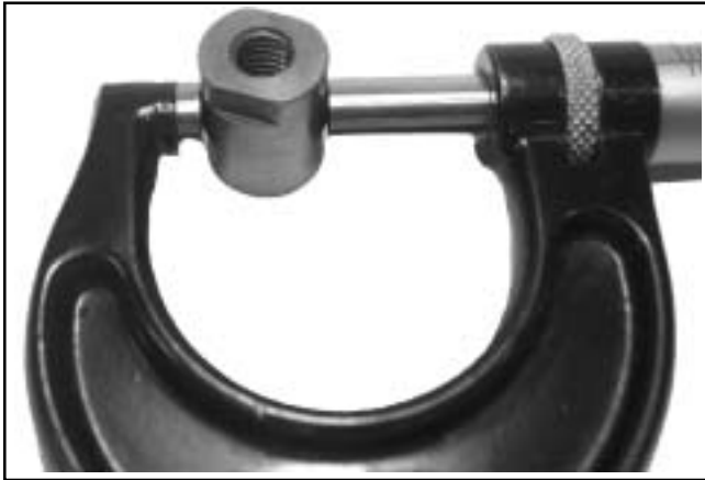
Figura 9-8. Misurazione del diametro esterno del perno guida.
