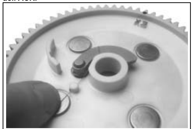
Figura 10-24. Fissaggio della molla dell'ACR sull'ingranaggio della camma di scarico.
