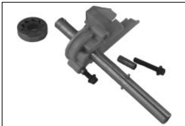
Figura 6-7. Pompa dell'olio sull'albero a camme di aspirazione (Gerotor smontati dall'alloggiamento della pompa).
