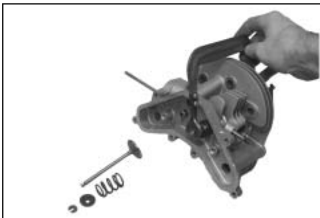
Figura 8-34. Rimozione delle valvole con il compressore per molle.
