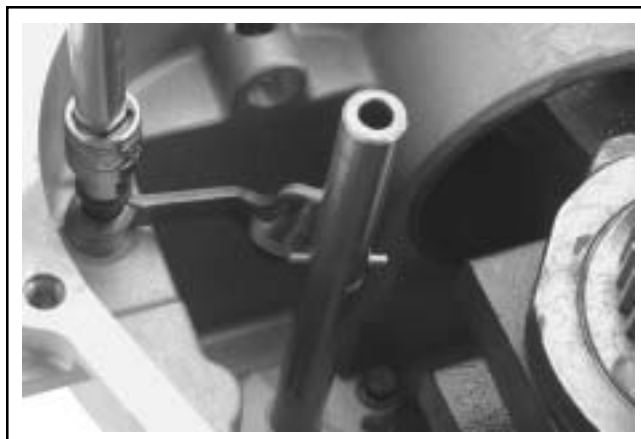
Figura 8-40. Rimozione delle leve delle camme.
