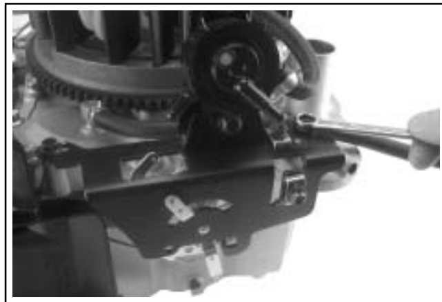
Figura 10-66. Fissaggio della staffa di comando dell'acceleratore.
