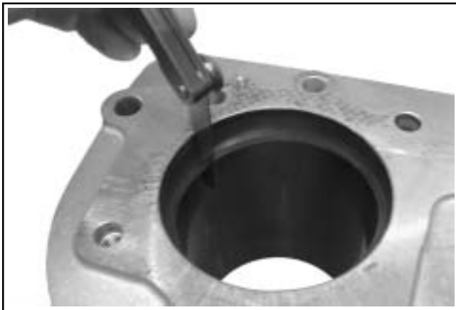
Figura 9-13. Misurazione del gioco finale dei segmenti del pistone.
