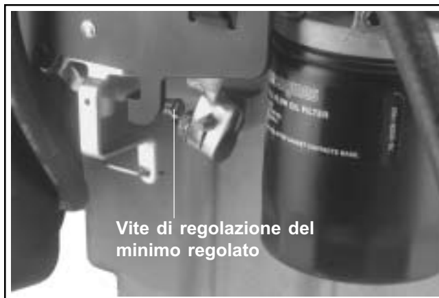
Figura 5-19. Posizione della vite di regolazione del minimo regolato.
