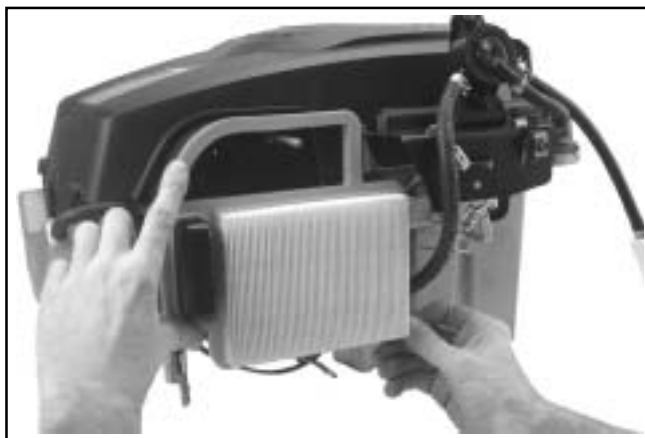
Figura 10-75. Installazione dell'elemento del filtro dell'aria.
