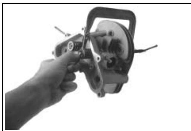
Figura 10-32. Montaggio della testata.
