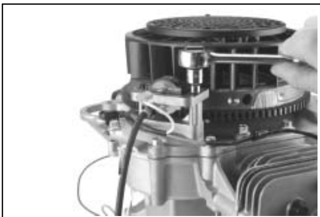
Figura 8-21. Rimozione del modulo di accensione.
