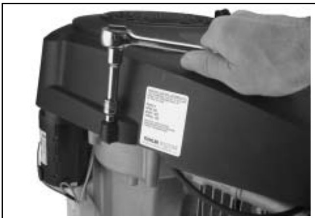
Figura 8-3. Rimozione delle viti del convogliatore dell'aria.
