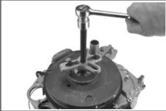
Figura 8-24. Rimozione del volano con un estrattore.
