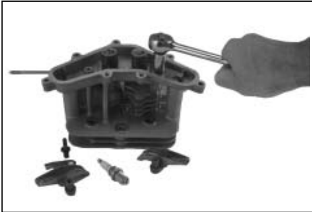
Figura 8-33. Smontaggio dei componenti dei bilancieri.
