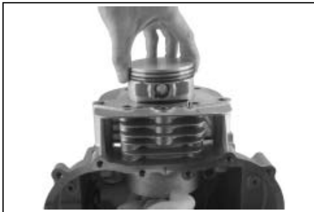
Figura 8-45. Rimozione di pistone e biella.
