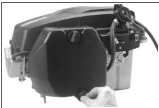
Figura 10-77. Installazione del coperchio del filtro dell'aria.
