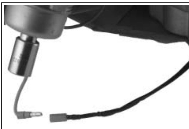
Figura 8-14. Scollegamento del cavo del solenoide del carburante.
