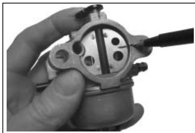
Figura 5-7. Marcatura di piastra dello starter e corpo del carburatore.
