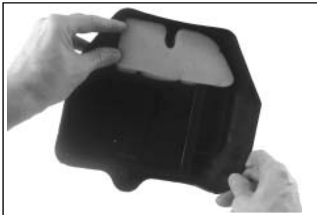
Figura 10-76. Installazione del prefiltro.
