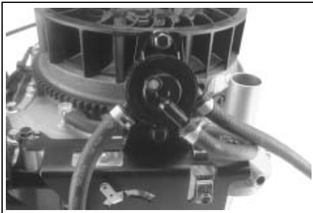
Figura 10-68. Installazione della pompa di alimentazione.
