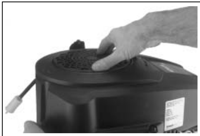
Figura 10-72. Installazione del retino per l'erba.
