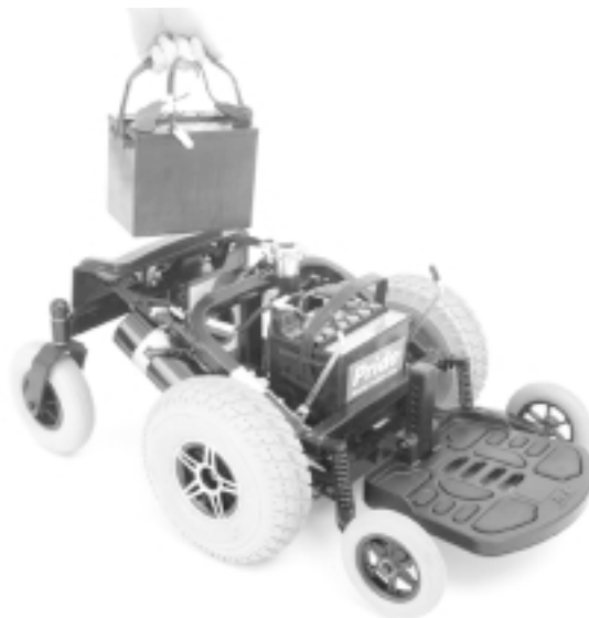
Figura 23. Rimozione delle batterie dal Jazzy 1103
