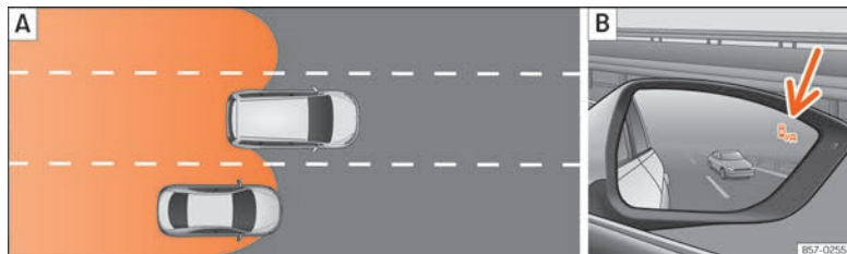
Fig. 244 Représentation schématique : A En cas de dépassement puis de retour sur la voie de droite. B Indication de l'assistant d'angle mort sur le rétroviseur extérieur droit.
