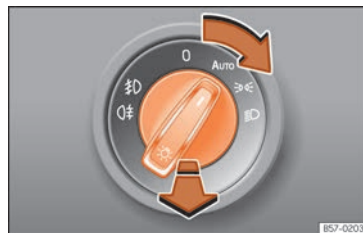
Fig. 41 Planche de bord : commande des feux.
