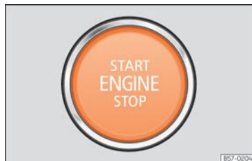
Fig. 215 Sur la partie inférieure de la console centrale : touche de démarrage.
