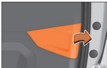
Fig. 109 Hayon arrière ouvert : retirer le cache.
