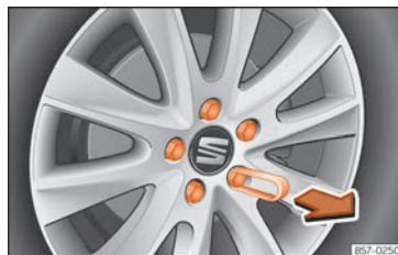
Fig. 71 Roue : boulons de roue avec capuchons.
