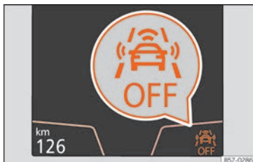
Fig. 231 Sur l'écran du combiné d'instruments : indication de Front Assist désactivé.
