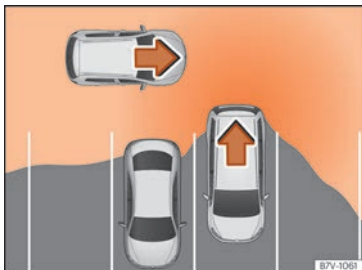
Fig. 245 Représentation schématique de l'assistant de sortie de stationnement : zone surveillée autour du véhicule sortant de stationnement.
