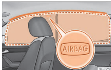
Fig. 28 Emplacement et zone de déploiement de l'airbag rideau.
