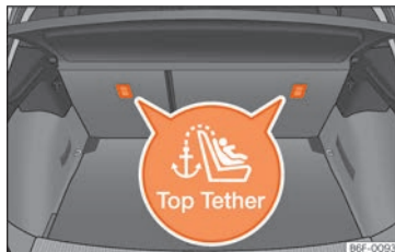
Fig. 38 Position des anneaux Top Tether sur la partie arrière de la banquette arrière.
