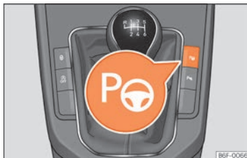
Fig. 247 Dans la console centrale : touche permettant de connecter le système de stationnement assisté.
