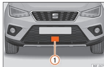
Fig. 235 Au niveau du pare-chocs avant : capteur radar.
