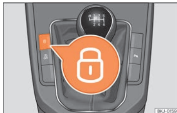
Fig. 5 Console centrale : touches de verrouillage centralisé.
