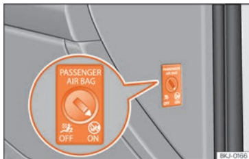
Fig. 94 Commande à clé permettant d'activer et de désactiver les airbags du passager avant.
