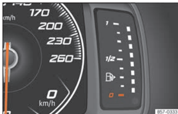
Fig. 122 Tableau de bord numérique : indicateur du niveau de carburant.
