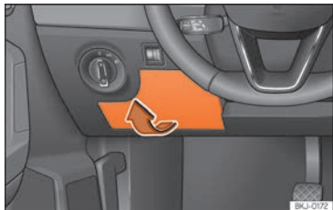
Fig. 63 Sur le tableau de bord côté conducteur : cache du boîtier de fusibles.
