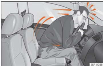
Fig. 90 Le conducteur n'ayant pas bouclé sa ceinture est projeté en avant.
