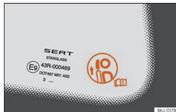
Fig. 87 Étiquette d'avertissement de la position de l'appuie-tête.
