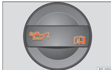
Fig. 59 Dans le compartiment-moteur : bouchon de l'orifice de remplissage d'huile moteur.
