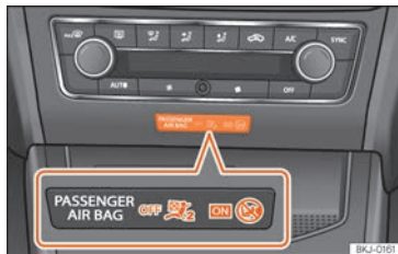
Fig. 95 Sur le tableau de bord, au centre : témoin de désactivation de l'airbag du passager avant.
