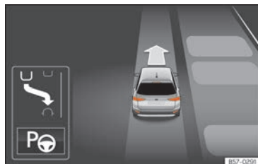
Fig. 249 Sur l'écran du combiné d'instruments : affichage du système de stationnement assisté avec affichage réduit.
