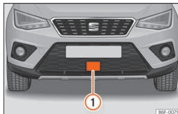
Fig. 230 Au niveau du pare-chocs avant : capteur radar.
