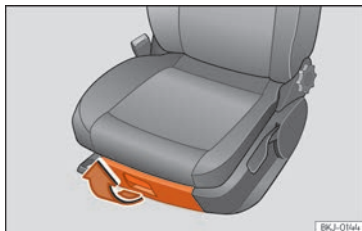
Fig. 154 Rangement sous le siège avant droit.
