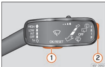
Fig. 125 Levier d'essuie-glace : touches de contrôle.
