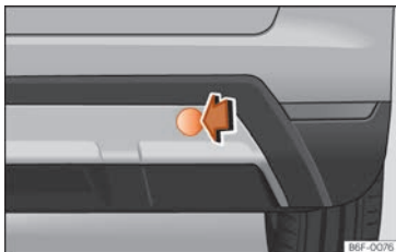
Fig. 99 Pare-chocs arrière droit : capuchon de protection
