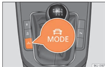
Fig. 246 À côté du levier de vitesses : touche MODE.
