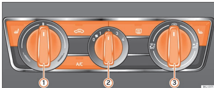
Fig.169 Sur le tableau de bord : éléments de commande du climatiseur
