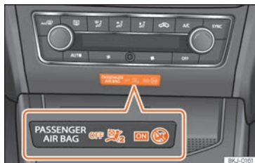
Fig. 25 Sur le tableau de bord, au centre : témoin de désactivation de l'airbag du passager avant.
