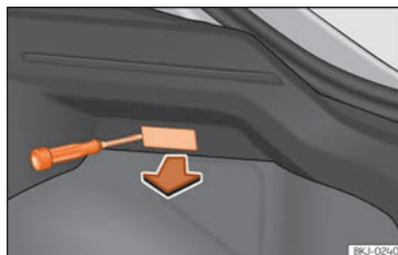
Fig. 113 Éclairage du coffre à bagages.
