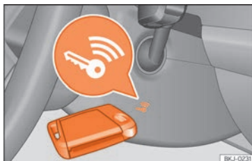
Fig. 216 À droite de la colonne de direction : démarrage d'urgence.
