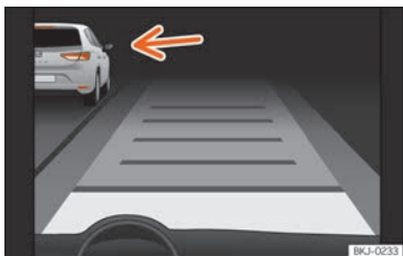
Fig. 238 Sur l'écran du combiné d'instruments : ACC activé, véhicule circulant à gauche détecté
