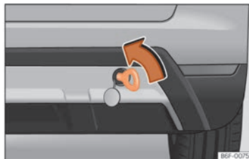
Fig. 100 Pare-chocs arrière droit : œillet de remorquage vissé
