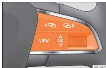
Fig. 126 Partie droite du volant multifonction : touches permettant d'utiliser les menus et les messages d'information du tableau de bord.
