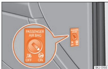
Fig. 24 Commande de l'airbag frontal du passager.
