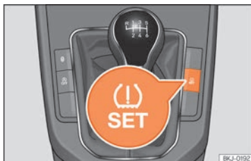
Fig. 284 Console centrale : touche du système de contrôle de la pression des pneus.
