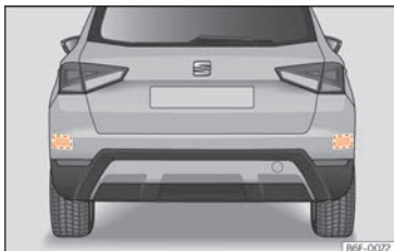
Fig. 242 Vue arrière du véhicule : zones des capteurs radars.
