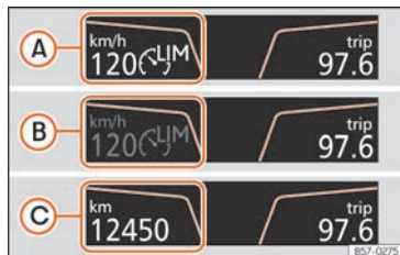
Fig. 226 Sur l'écran du combiné d'instruments : indications de l'état du limiteur de vitesse.
