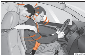
Fig. 91 L'occupant de la banquette arrière non attaché est projeté en avant et vient heurter le conducteur attaché.
