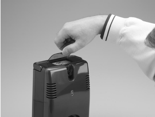
Figure 23 : Soulèvement de la protection anti-poussière du pavé numérique
