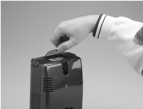
Figur 23: Öppna dammskyddet över knappsatsen
