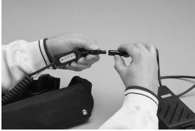
الشكل رقم 8: شحن بطارية حزام AirBelt
