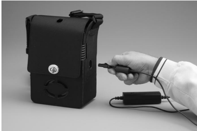
Figur 7: Ladda det inbyggda batteriet
