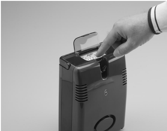
Figure 24 : Pressez le bouton de sélection du débit
