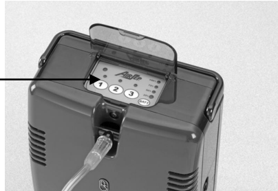
Figur 25: Indikator för obligatorisk inspektion/service
