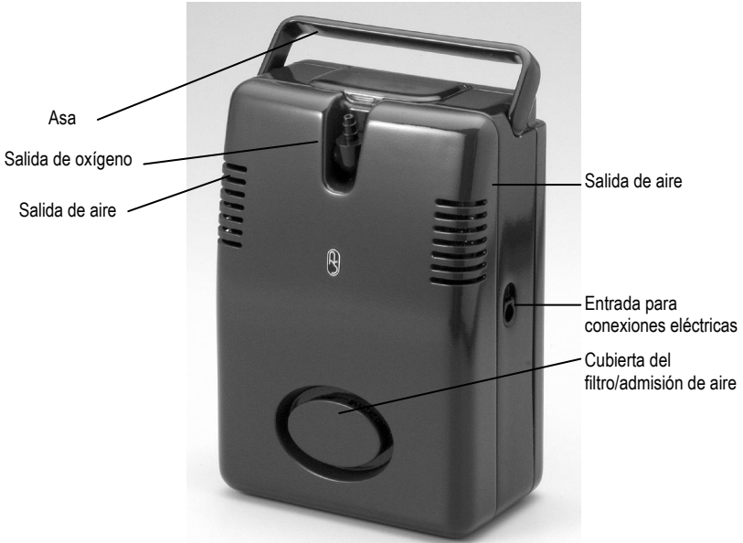
Figura 10: Vista exterior frontal de la unidad FreeStyle
