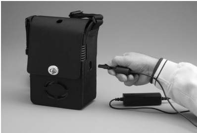
Abb. 7: Laden der internen Batterie
