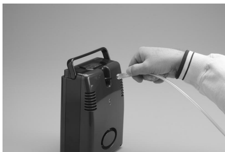
Figur 9: Tilslutning af iltbrille til iltudtaget på FreeStyle
