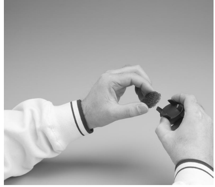
Figura 22: Retirada do filtro da entrada de ar
