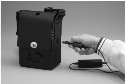
Figure 7 : Recharge de la batterie interne
