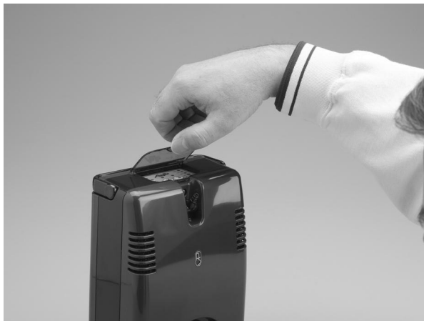
Figura 23: Como levantar a tampa de proteção contra poeira no visor do teclado
