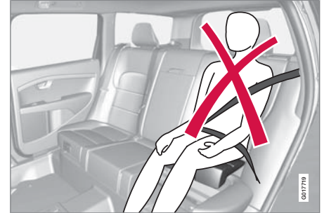
Position assise incorrecte : la tête de l'enfant dépasse l'appui-tête et le baudrier n'est pas placé en travers de la clavicule
