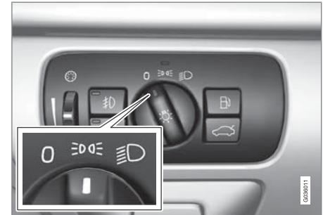
Position de la commande des phares pour allumer les feux de stationnement
