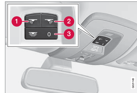
Interrupteurs d'éclairage, éclairage de pavillon avant
