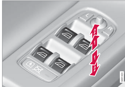
Fonctionnement des vitres électriques
