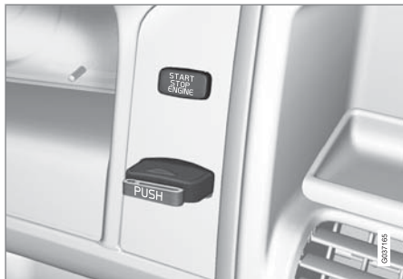
Commutateur d'allumage avec clé-télécommande insérée (voir page 84 pour de plus amples renseignements sur les modes d'allumage)
