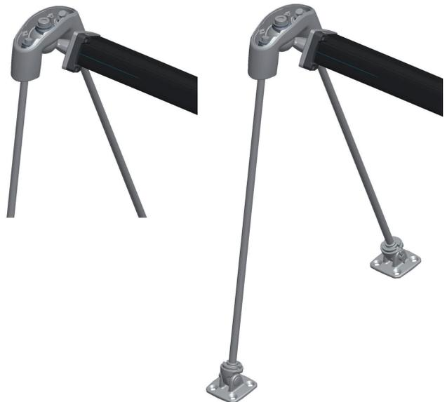
Marquez la position de fixation de pont ou des trous des tiges filetées. Il se peut que la longueur du rail doive être ajustée pour correspondre à l'emplacement des fixations de pont.
