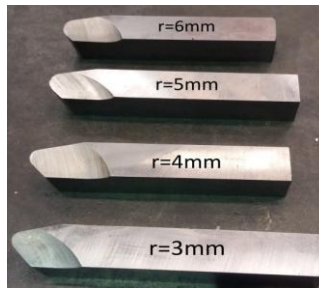
Fig. 14. Herramientas de corte afiladas con diferentes radios de punta
