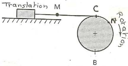
Un moteur actionne un cylindre qu'il fait tourner à la vitesse angulaire constante de  $20 \text{ tr} \cdot \text{min}^{-1}$ .
