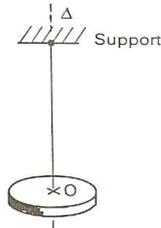
Un disque homogène de rayon  $r = 10 \text{ cm}$  et de masse  $m = 200 \text{ g}$  est suspendu par son centre O à un fil de torsion vertical, dont l'extrémité est soudée à un support fixe.
