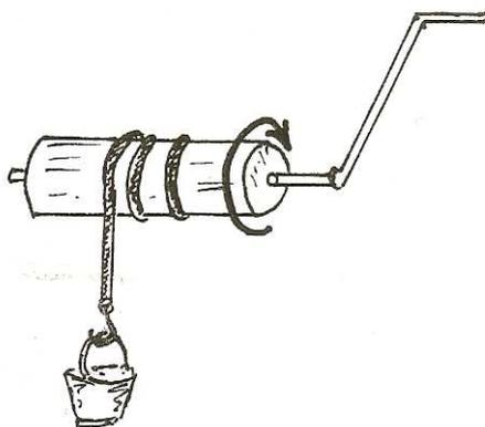
Un **treuil** est constitué d'un cylindre de rayon  $r$  et de masse  $M$ , sur l'axe horizontal duquel est fixée une manivelle de longueur  $L$ .
