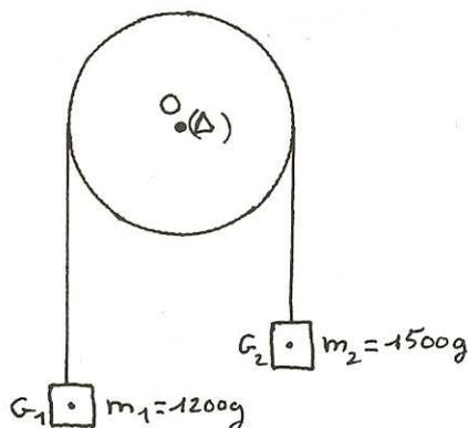
Poulie de masse négligeable, mobile autour d'un axe  $\Delta$  perpendiculaire au plan de la figure en O.
