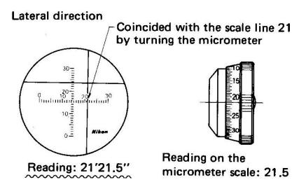
Fig.10.2. Micrometer scale
