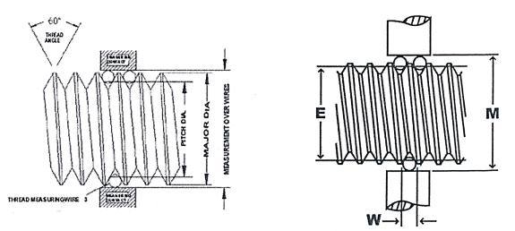
Fig. 11.2. Screw thread parameters
