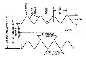
Fig.8.1. Screw Thread profile / parameters
