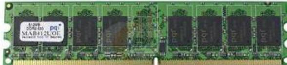
Los módulos DD3 también utilizan 240 contactos, aunque como son incompatibles eléctricamente, tiene la "mueca" de identificación (cortes en forma de "media luna" que poseen en ambos extremos y en el medio) en otro lugar para evitar confusiones.
