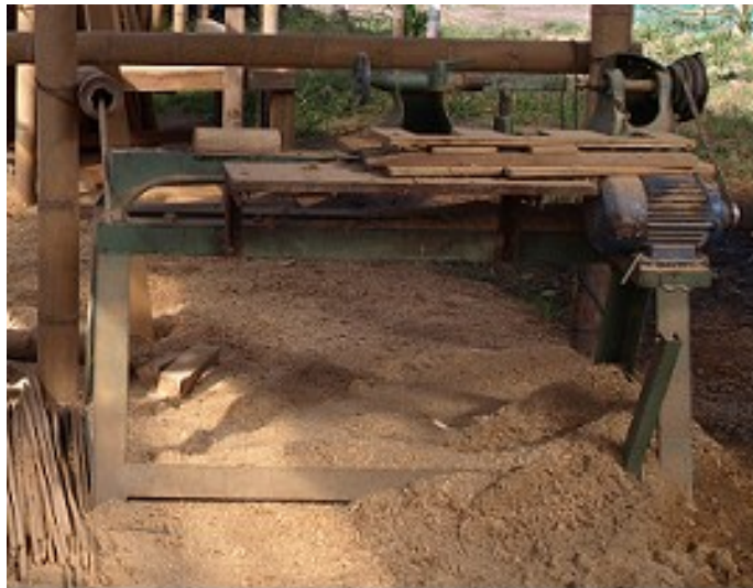
Figura 5: Máquina Torneadora de madera y guadua
