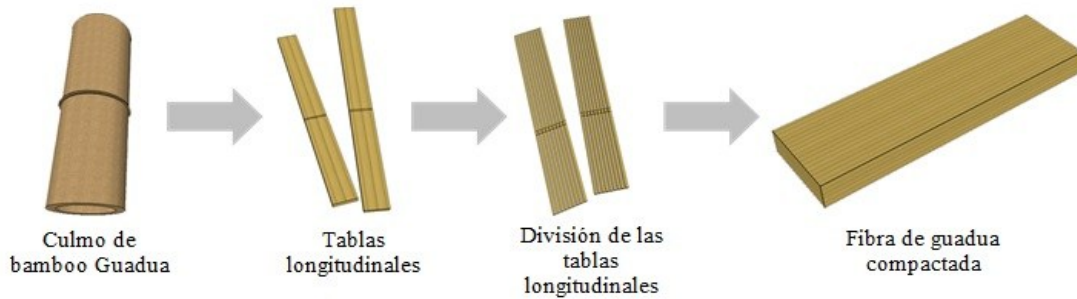
Figura. 1 Proceso de Fabricación de fibra de guadua compactada
