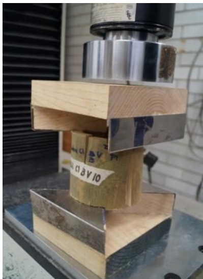
Figura 1. Pruebas de cortante y gráfica comparativa resultante, para las tres especies analizadas Dr. Magdalena Trujillo, Mexico, UNAM, 2013
