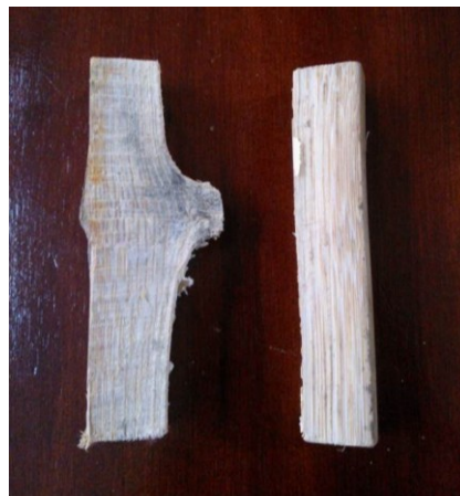
Figura 3. Probetas con las dimensiones propuestas con nudo y sin nudo. Fuente: Autor
