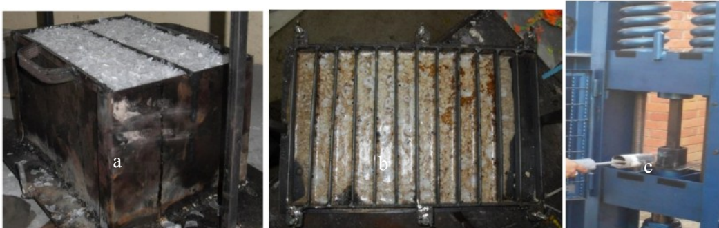
Figura 1. Obtención y procesamiento del PET reciclado. a) peletizado. b) moldeado. c) elaboración de probetas con presión.
