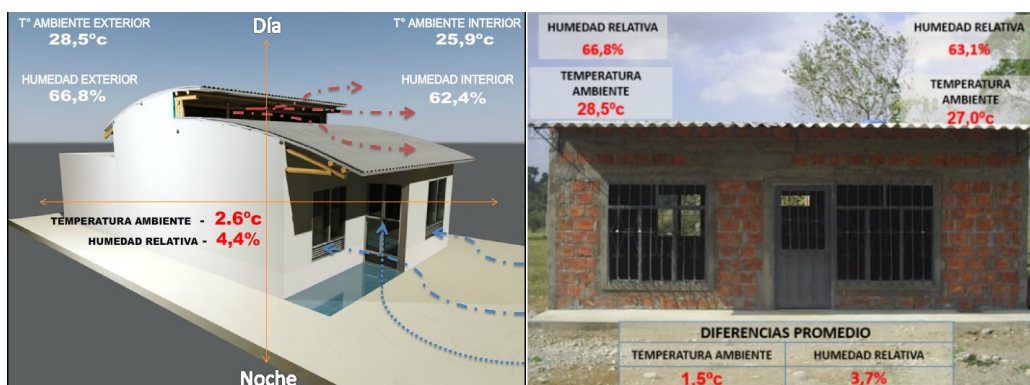
Figura 5. Análisis variables temperatura ambiente y humedad relativa modelo constructivo sostenible y modelo constructivo convencional
