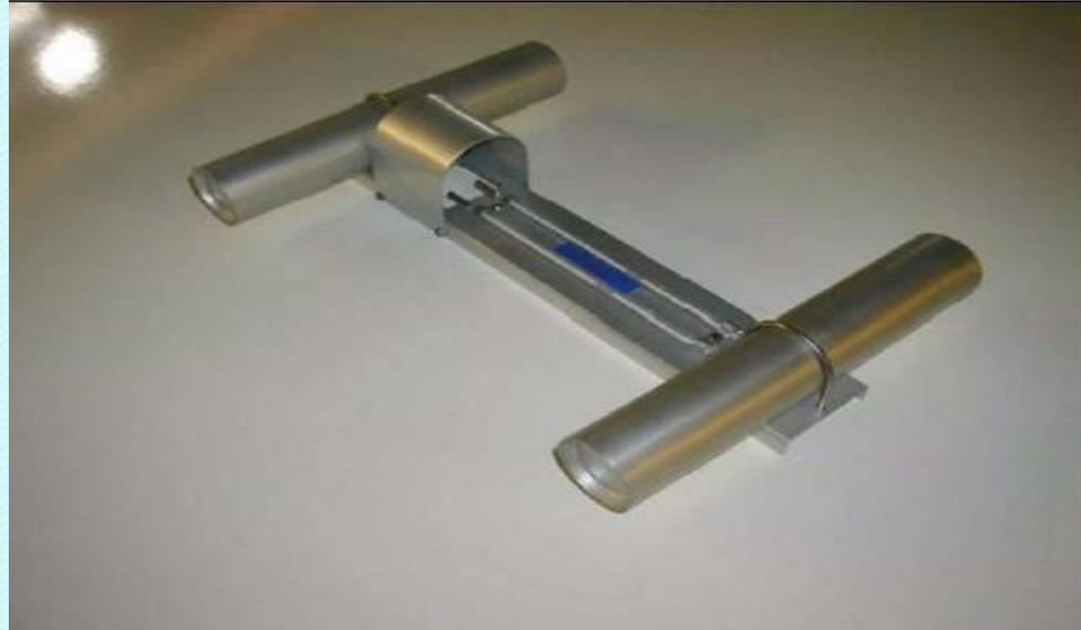
Thermometer ini merupakan bagian/ kelengkapan dari alat evaporasi panci terbuka. Berfungsi untuk mengetahui suhu permukaan air yang terjadi di permukaan bumi/ tanah. Terdiri dari thermometer maksimum (thermometer air raksa) dan thermometer minimum (thermometer alcohol). Suhu rata-rata air didapat dengan menambahkan suhu maksimum dan minimum, kemudian dibagi dua.
