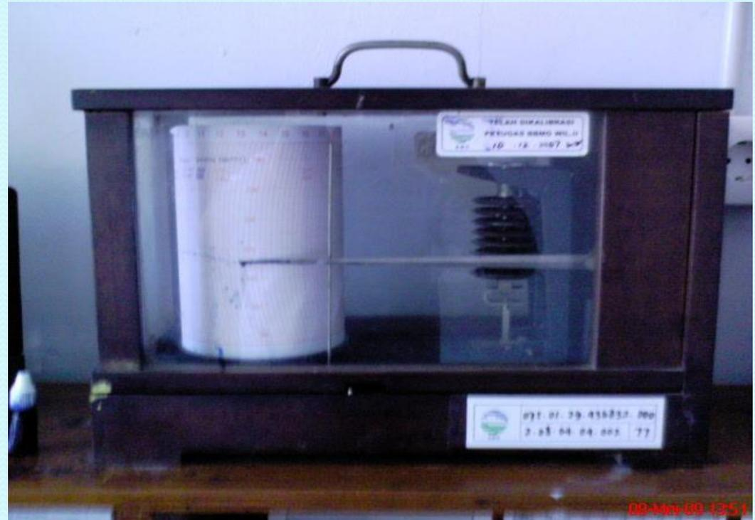
Fungsi alat untuk mengukur tekanan udara dengan satuan mb / hpa dibaca setiap jam
