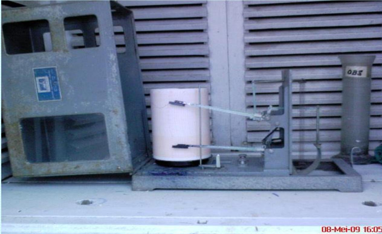
Thermohygrogrpah , berfungsi untuk mengukur suhu dan kelembaban secara otomatis
