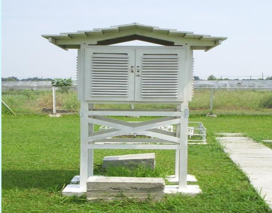
Sangkar Meteorologi, berfungsi untuk meletakkan peralatan meteorologi.
