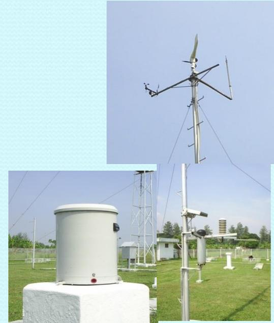
AWS , berfungsi untuk mengukur unsur2 cuaca secara otomatis ( sensor )
