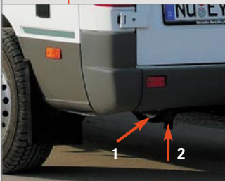
Abwassertank ca. 80 l: Entleerungsventil (1), Ablauföffnung (2)
