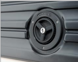
Einfüllstutzen Frischwassertank ca. 100 l
