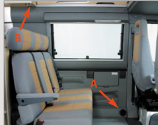
Auströmöffnung (A) und Bedienteil der Gasheizung (B)
