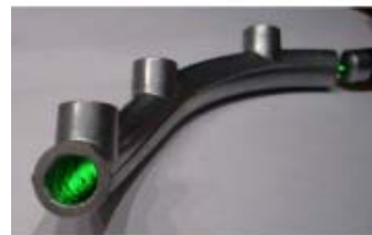
Durch Gasinjektion hergestelltes Druckgussteil (L. Kallien et al. 2012)
