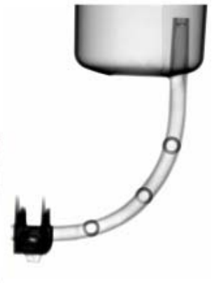
Durch Gasinjektion hergestelltes Druckgussteil (L. Kallien et al. 2012)
