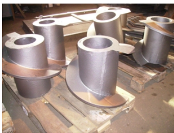
Spezielle Förderschnecken aus Hartguss, die zum dosierten Transport unterschiedlichster Erzeugnisse eingesetzt werden.
