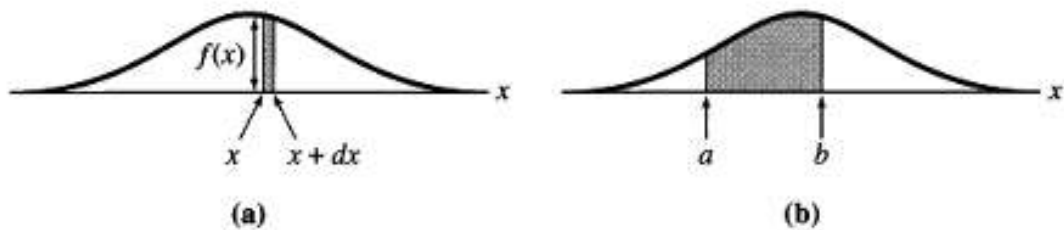
Gambar 5.5 Batas distribusi f(x) . (a) setelah banyak pengukuran, fraksi berada pada x dan x+dx . (b) fraksi berada pada x=a dan x=b
