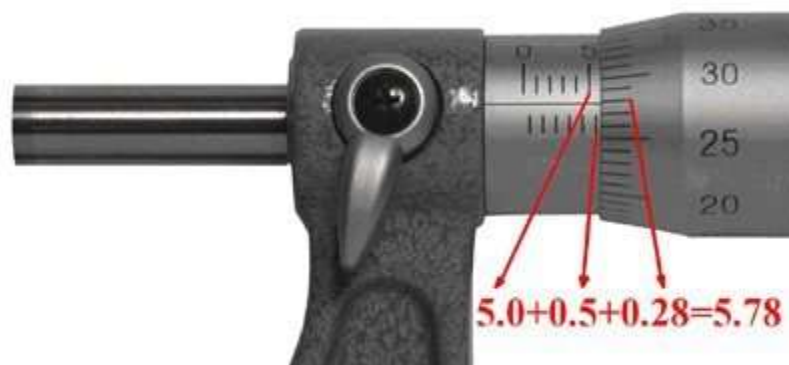
Gambar 4.4 Membaca Mikrometer Sekrup
