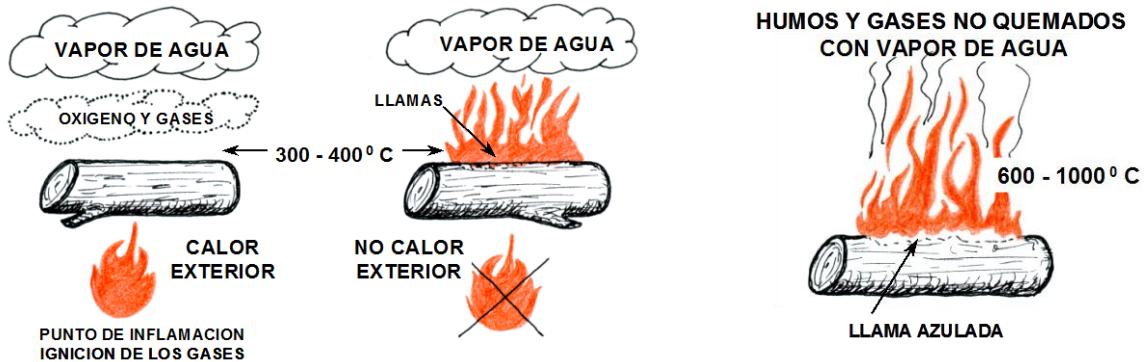
Fig. 8: Fase de combustión de los gases
