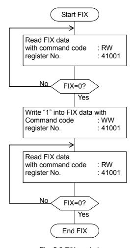
Fig. 5-3 FIX prodedure
