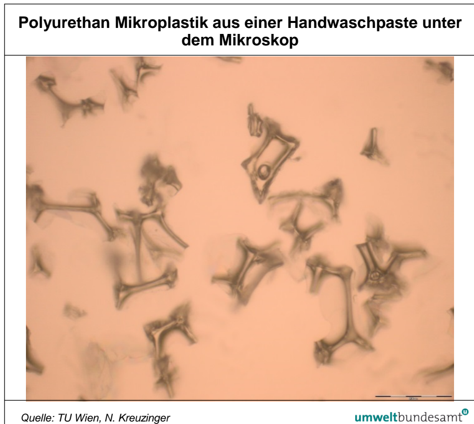
Abbildung 2: Polyurethan Mikroplastik aus einer Handwasch- paste unter dem Mikroskop, ca. 200 \mu\text{m} Partikelgröße.
