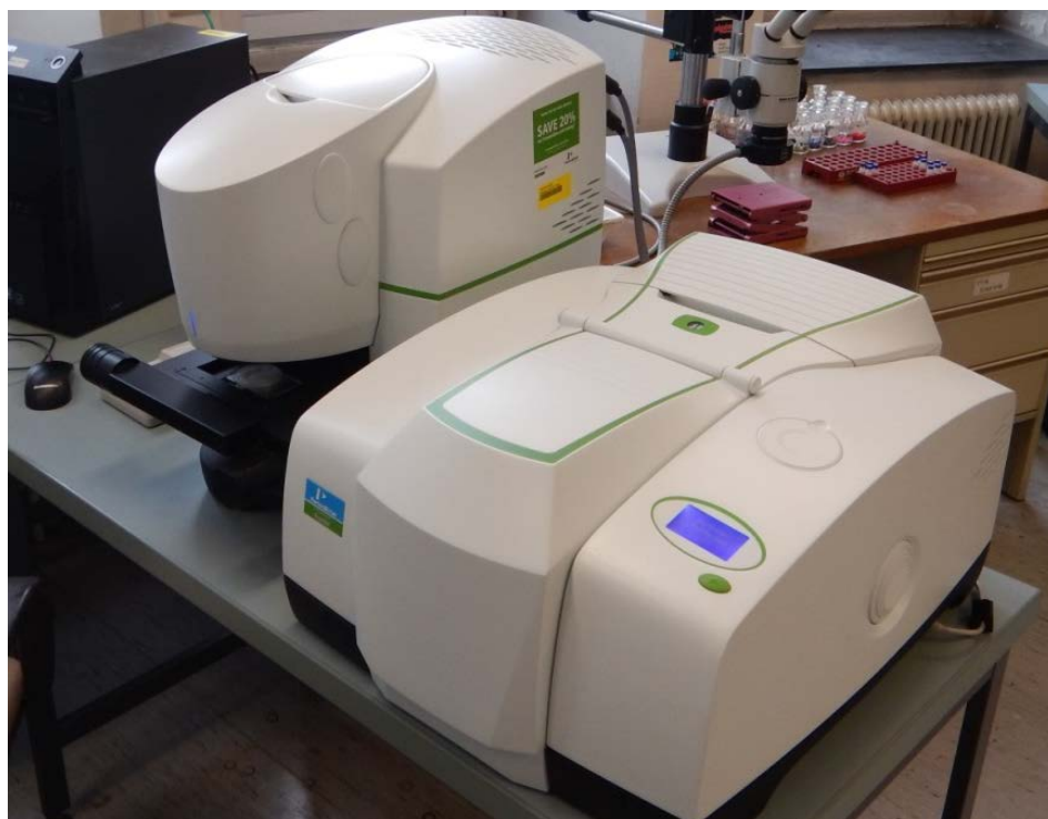
Abbildung 4: FT-IR Spektrometer mit Imaging Funktion, Gerät implementiert für die Mikroplastik-Analytik am Umweltbundesamt. © S. Schaden/ Umweltbundesamt
