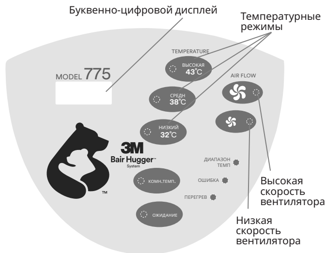
Рисунок С. Панель управления устройства для обогрева модели 775
