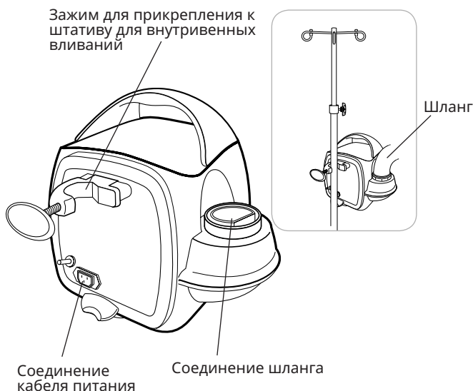
Рисунок В. Устройство для обогрева модели 775 — вид сзади
