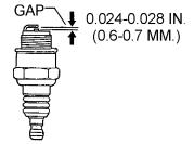
Figure 23. Spark Plug Gap
